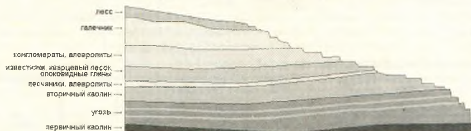
Разрез Ангренского каолино-угольного месторождения
