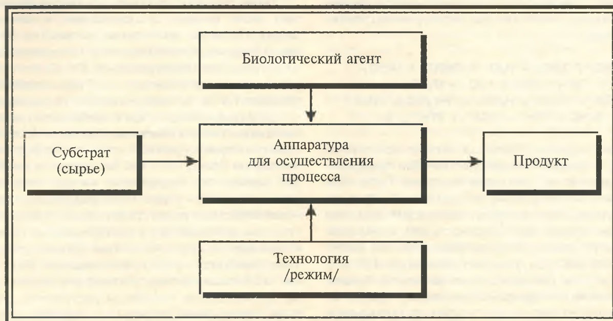
Рис.1. Основные компоненты биотехнической системы /5/
