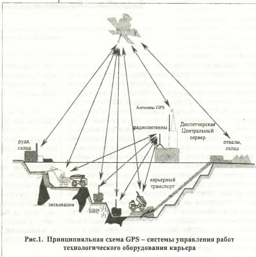
Рис.1. Принципиальная схема GPS – системы управления работ технологического оборудования карьера
