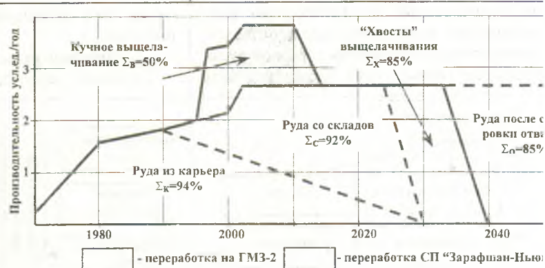
Рис. 4. Структура переработки руды карьера Мурунтау: \Sigma_v — извлечение золота при переработке
