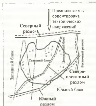
Рис. 1. Схема расположения разрушающих деформаций на карьере Мурунтау по состоянию на 01.10.99г.
