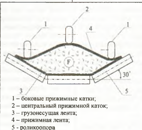
Рис. 1. Поперечное сечение конвейера
