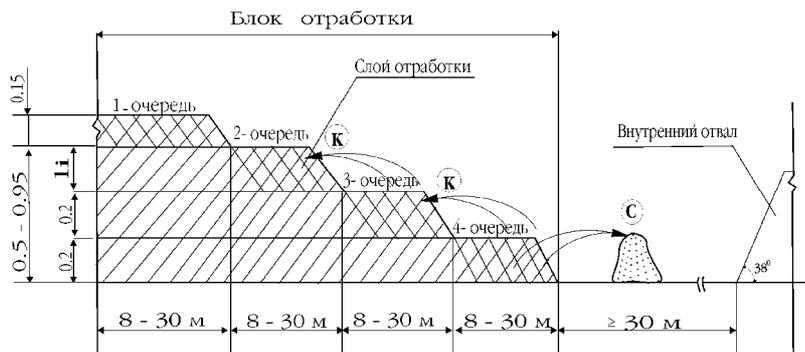
Рис. 4. Ступенчатая схема отработки фосфопласта
