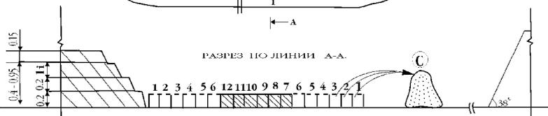
Рис. 6. Кольцевая схема отработки фосфопласта
