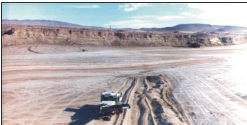
Рис. 1. Отсыпка слоя зачистки на безрудную зону
