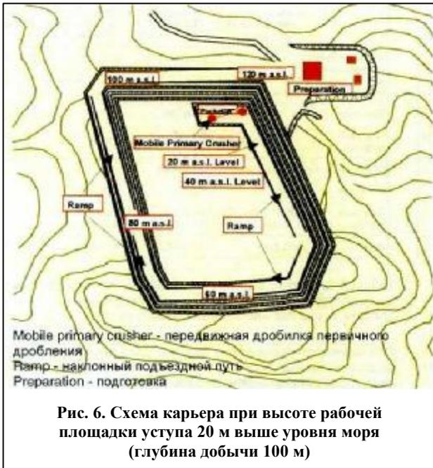
Рис. 6. Схема карьера при высоте рабочей площадки уступа 20 м выше уровня моря (глубина добычи 100 м)
