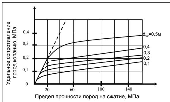
Рис. 3. Зависимость удельного сопротивления разрыхленного массива копания от предела прочности пород на сжатие при различном среднем размере куска взорванной горной массы
