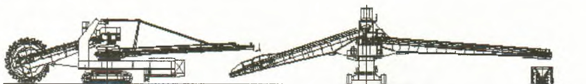
Рис. 3. Роторный экскаватор, самоходный конвейерный перегружатель, комбинированная самоходная загрузочная и кабельная тележка, конвейерная установка
