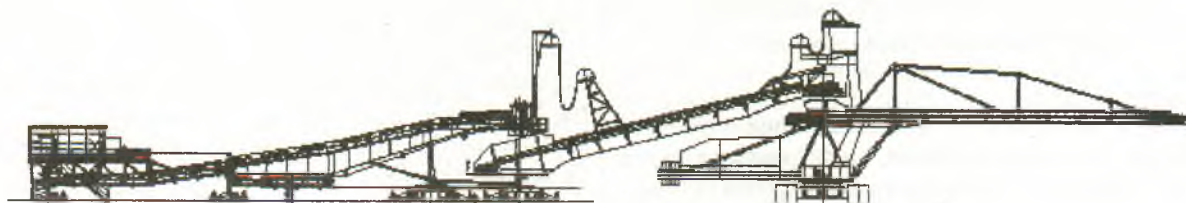
Рис. 4. Конвейерная установка, передвижной телескопический конвейер, отвалообразователь
