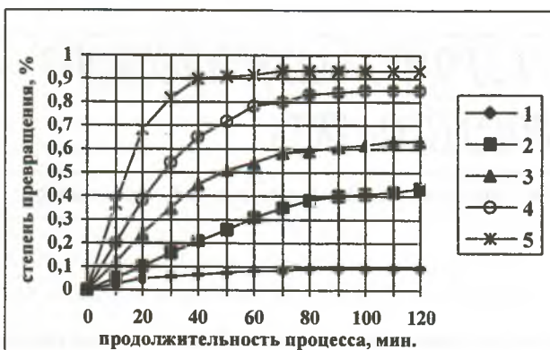
Рис. 1. Влияние продолжительности паробожига на степень превращения медно-молибденового продукта (условия опытов: масса продукта 10 г, 13-15 мл/мин, скорость вращения печи 0,25 об/мин. 1-500°С; 2-600°С; 3-700°С; 4-800°С; 5-900°С)
