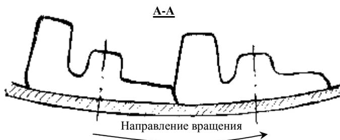
Рис. 9. Футеровка цилиндрической части барабана мельницы с изменённым профилем
