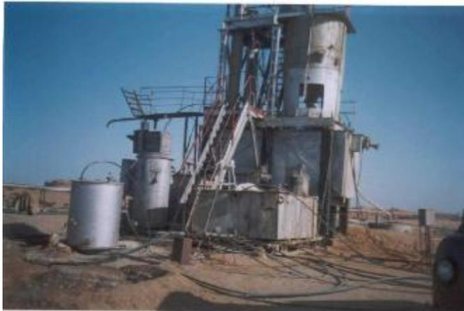
Рис. 3. Установка, смонтированная на участке ПВ для культивирования бактерий и подачи бактериальных растворов в пласт
