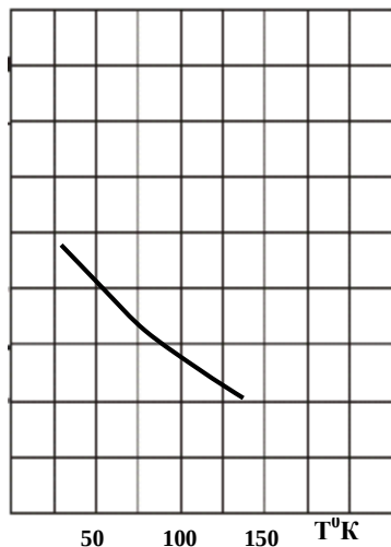
Рис. 1. Зависимость коэффициента теплопроводности горных пород от температуры
