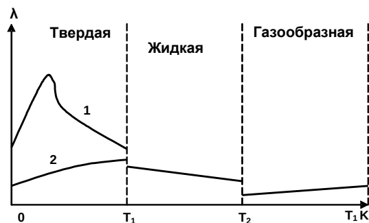
Рис. 3. Температурная зависимость теплопроводности от твердой, жидкой и газообразной фаз горной породы
