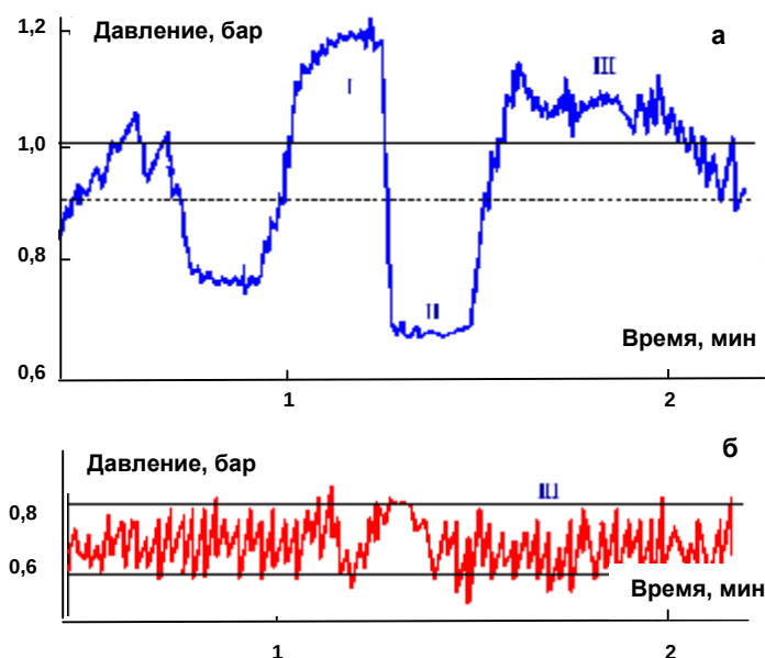
Рис. 1. Диаграммы давления пульпы на входе в гидроциклоны без системы поддержания давления (а) и при системе автоматического поддержания и стабилизации давления (б)
