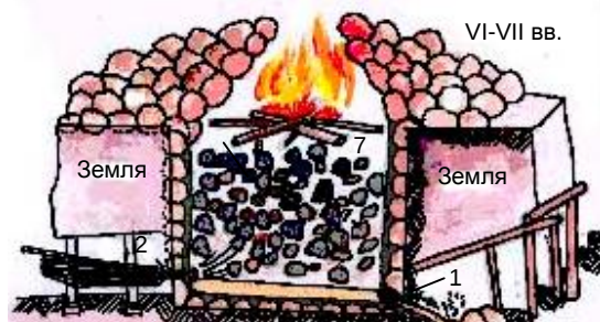
Рис. 3. Более совершенная конструкция печи: 1 - летка, 2 - меха
