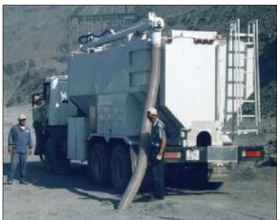
Рис. 4. Заряжание скважин Нобеланом при помощи СЗМ типа Heavy ANFO
