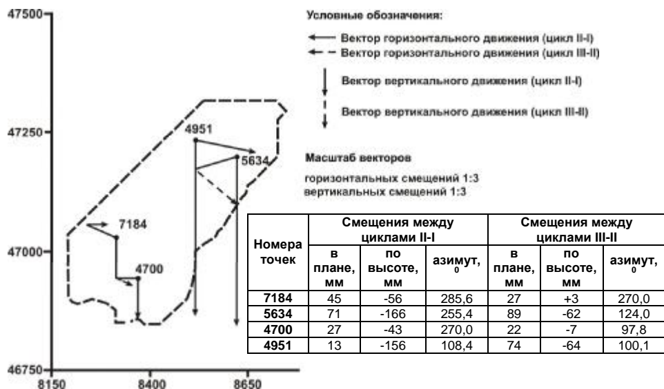
Рис. 2. Схема расположения рабочих реперов слежения и графики их горизонтальных и вертикальных смещений оползня Верхне-Туркский
