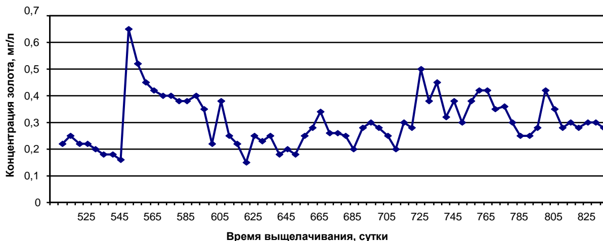
Рис. 2. Зависимость концентрации золота в продуктивном растворе от продолжительности выщелачивания при разных паузах орошения
