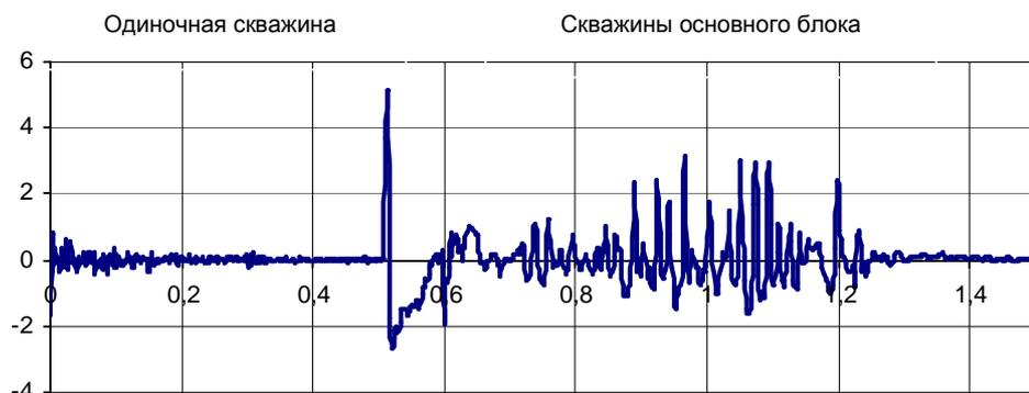
Рис. 2. Сейсмограмма колебаний массива от экспериментального взрыва второй серии
