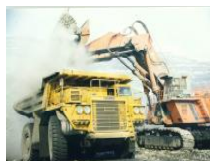
Рис. 5. Гидравлический экскаватор EX-3500 в работе
