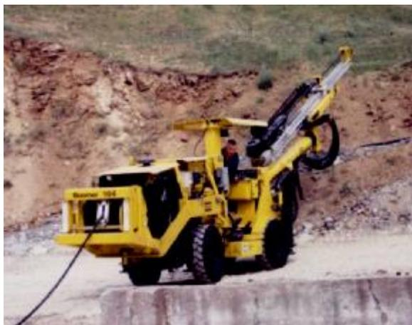
Рис. 1. Гидравлическая буровая установка Boomer 104-1238 фирмы Atlas Copco на промплощадке Каульдинского рудника
