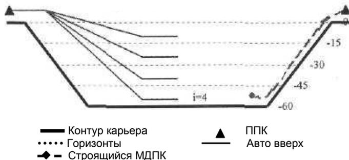
Рис. 1. Схема грузопотоков на этапе применения автомобильного транспорта
