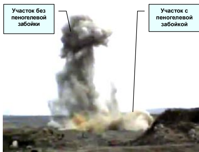
Рис. 2. Образование пылегазового облака над участком блока с пеногелевой забойкой и без нее
