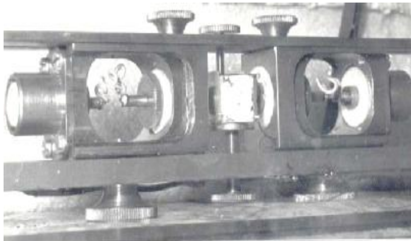
Рис. 2. Держатель с образцом, подготовленным для измерений
