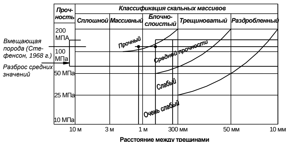
Рис. 3. Диаграмма классификации скальных массивов, предложенная Мюллером применительно к руднику С.С.А., Кобар [6]. Оценка прочности скальных массивов: прочный массив — сцепление 70,2 МПа, угол трения >40^\circ ; массив средней прочности — сцепление 0,1-0,2 МПа, угол трения 30-40^\circ ; слабый массив — сцепление 10-100 кПа, угол трения 20-30^\circ ; очень слабый массив — сцепление <10 кПа, угол трения <20^\circ . Под прочностью подразумевается прочность ненарушенной породы на сжатие. Классификация скальных массивов: сплошной — практически без трещин; массивный — слегка трещиноватый; блочно-слоистый — умеренно трещиноватый; трещиноватый — сильно нарушенный; раздробленный
