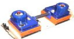
Рис. 1. Внешний вид георадара типа «ОКО-М» (а) и «ОКО-М1» (б)
