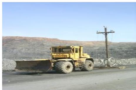
Рис. 6. Колесный бульдозер ДЗ-48 на базе трактора К-702
