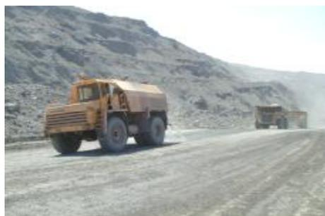
Рис. 5. Поливооросительная машина на базе а/с БелАЗ-75486
