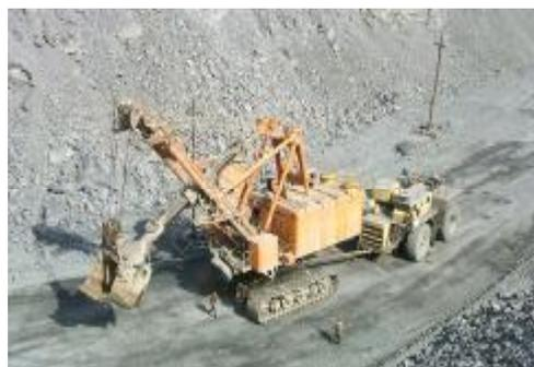
Рис. 9. Перегон экскаватора в карьере с помощью перегоночного комплекса
