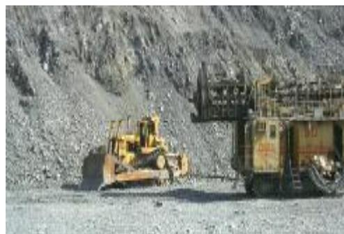
Рис. 10. Перегон бурового станка с помощью гусеничного бульдозера D10N
