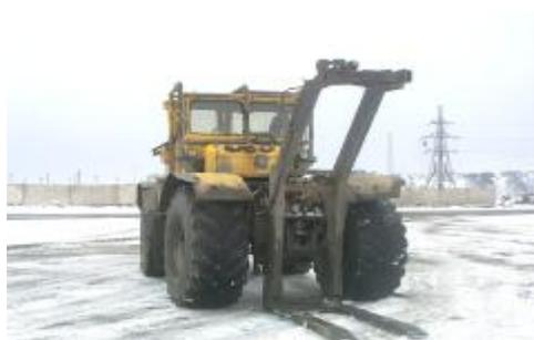
Рис. 7. Опороперевозчик на базе трактора К-701
