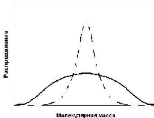
Рис. 8. Два полимера с одинаковым значением средней молекулярной массы, но различным распределением молекулярной массы
