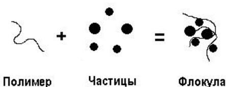
Рис. 4. Флокуляция частиц твердой фазы
