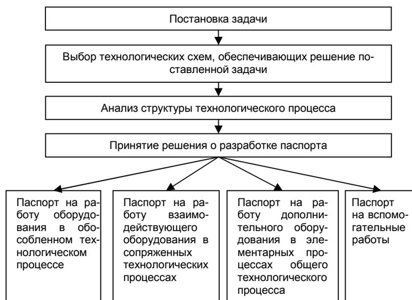
Рис. 2. Схема принятия решения о разработке паспорта на горные работы
