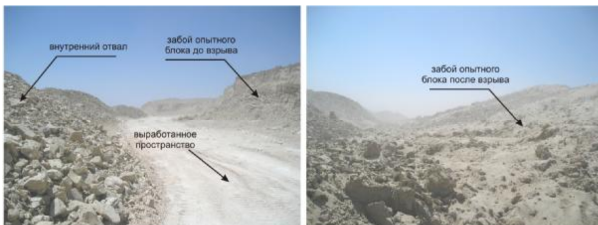
Рис. 2. Вид опытного блока: а) до взрыва и б) после взрыва
