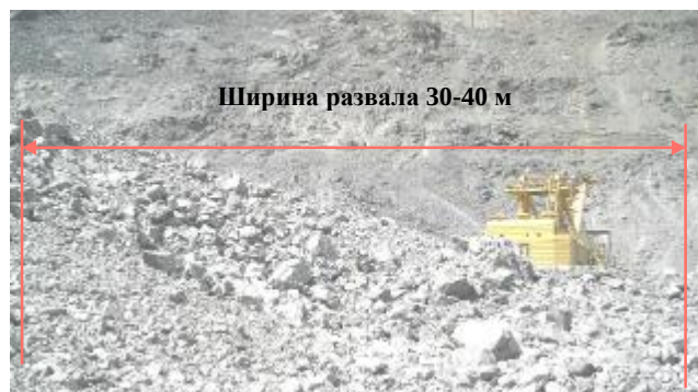
Рис. 2. Развал взорванной горной массы от взрыва с повышенным удельным расходом ВВ
