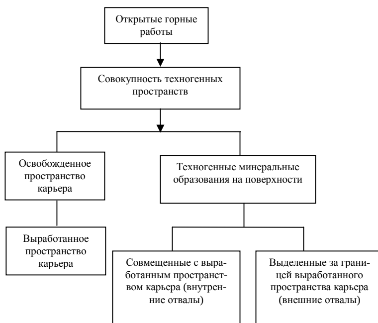
Рис. 1. Схема открытых горных работ как системы освобождаемых и заполняемых пространств
