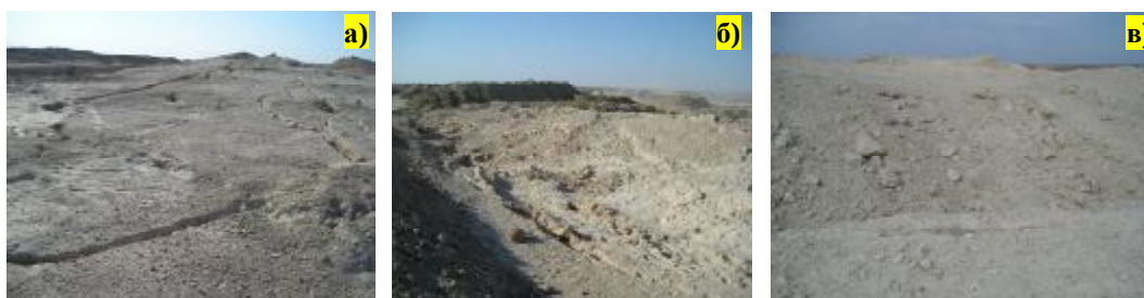
Рис. 7. Вид поверхности взорванного блока при применении сплошных (а) и рассредоточенных (б) зарядов, а также развала взорванной горной массы при рассредоточенных зарядах (в)
