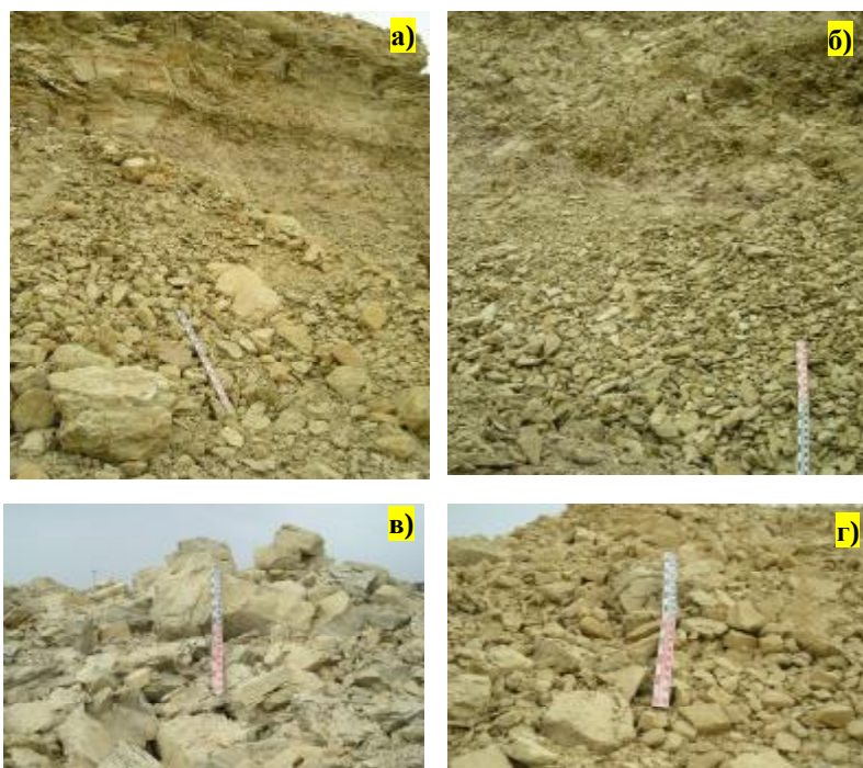
Рис. 10. Степень дробления горной массы при применении скважин диаметром 250 мм (а) и 215 мм (б) при сетке скважин 7х7 м и использовании игданита, скважин диаметром 250 мм (в) и 215 мм (г) при сетке скважин 8х8 м и использовании нобелана
