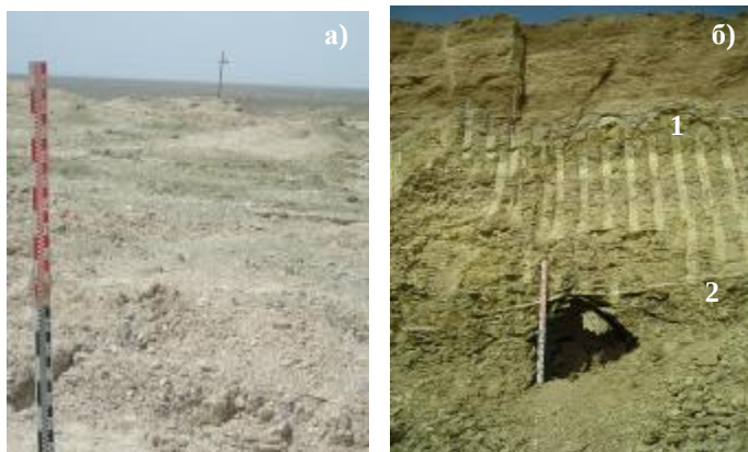
Рис. 3. Поверхность взорванного блока (а) и забой экскаватора (б) при обустройстве разнопрочного массива на всю высоту вскрышного уступа: 1- непроработанная часть; 2 – камуфлетная полость
