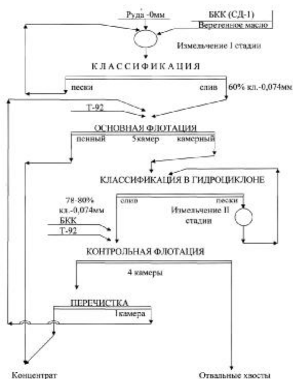
Рис.1. Технологическая схема полупромышленных испытаний реагента СД-1
