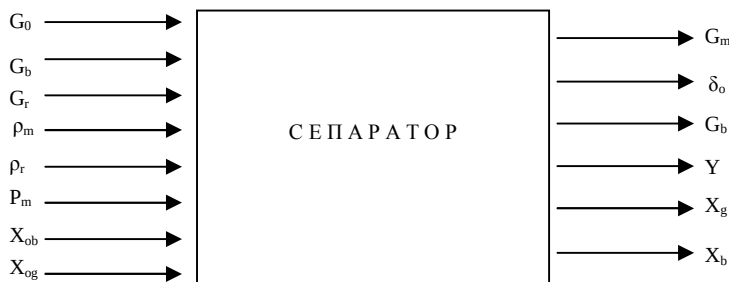
Рис. 2. Система пневмосепарирования золотосодержащих руд и факторов, влияющих на процесс
