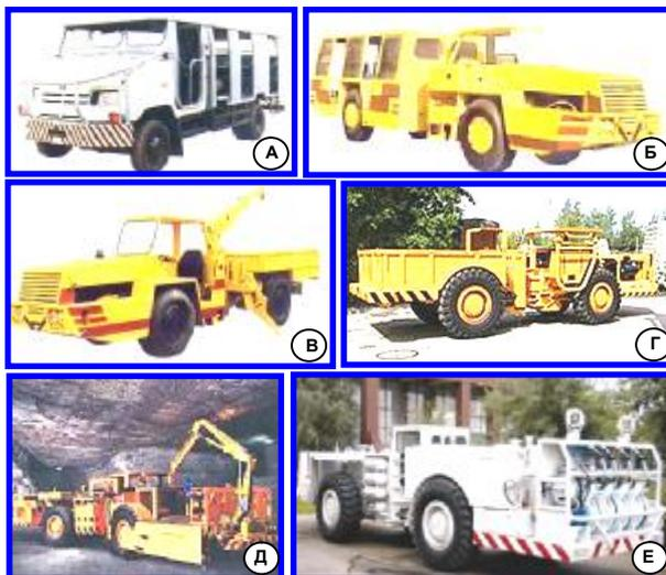
**Рис. 1.** Самоходные вспомогательные машины: А - УКР (Л); Б - 1ВЛГА; В - 1ВОМА; Г - SWT-3К; Д - SWT-3S/A; Е - SWPS-3(5Z)
