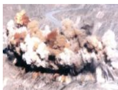
Рис. 4. Формирование пылегазового облака в карьере по стадиям развития взрыва в зажатой среде
