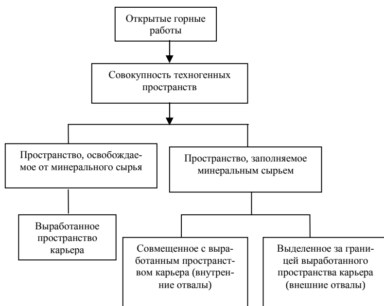
Рис. 1. Схема открытых горных работ как системы пространственных техногенных ресурсов
