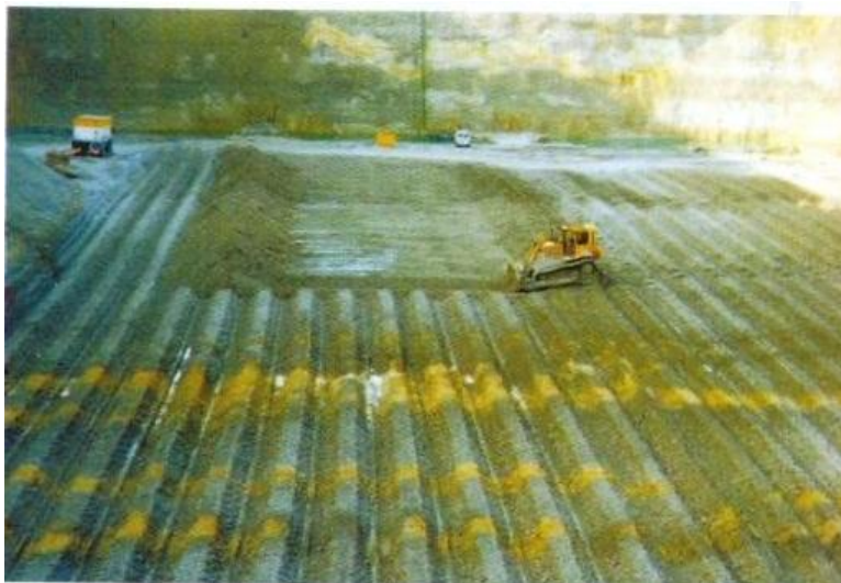
Рис. 9. Оработка на «валки» пласта сложной полосчатой структуры на месторождении Lakhanpur (Индия)
