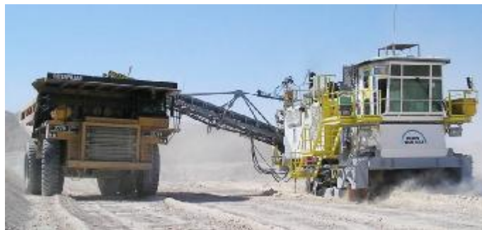
Рис. 3. Добыча руды комбайном MTS-250 с погрузкой в самосвал CAT-777D
