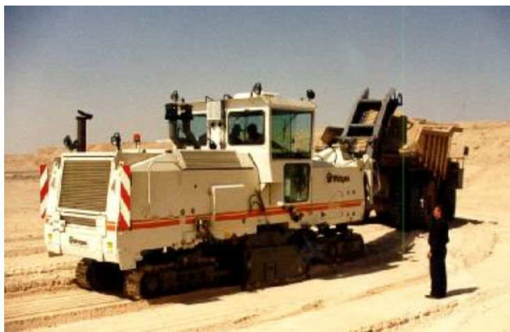
Рис. 2. Комбайн Wirtgen 2100 в комплекте с самосвалом БелАЗ-540
