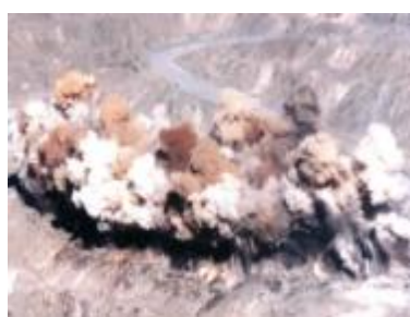
Рис. 4. Формирование пылегазового облака в карьере по стадиям развития взрыва в зажатой среде
