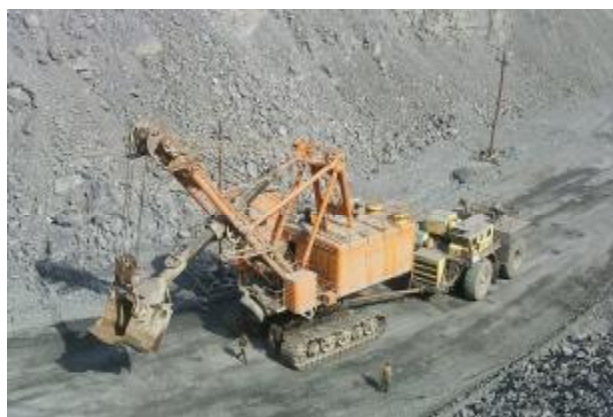
Рис. 5. Перегон экскаватора в карьере с помощью перегонного комплекса
