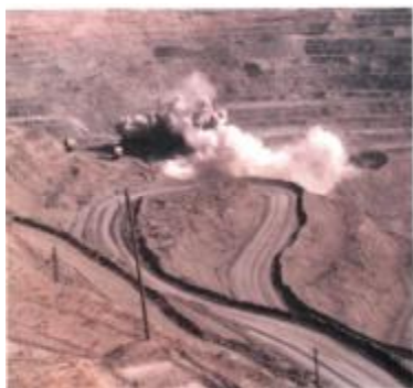
Рис. 1. Процесс формирования и распространения пылегазового облака при массовых взрывах в карьере
