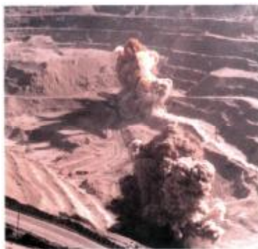
Рис. 1. Процесс формирования и распространения пылегазового облака при массовых взрывах в карьере
