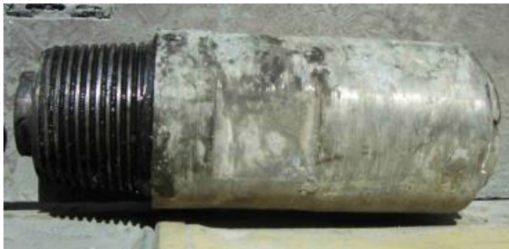
Рис. 2. Состояние амортизатора АН-200 после проходки 3000 п.м
