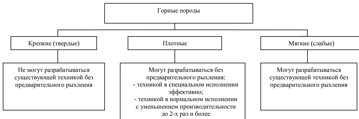
Рис. 1. Схема разделения пород с технологических позиций ведения горных работ
