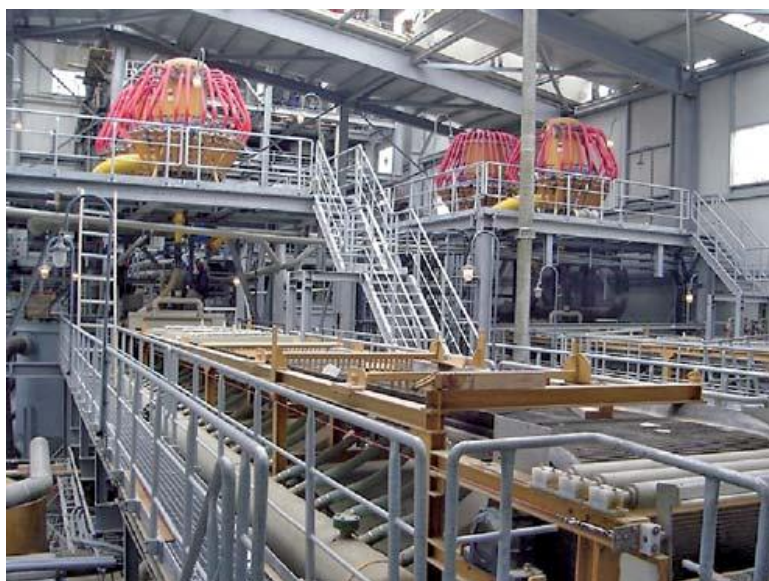
Рис. 3. Ленточный вакуум-фильтр (первая и вторая стадии гидроциклонирования)
