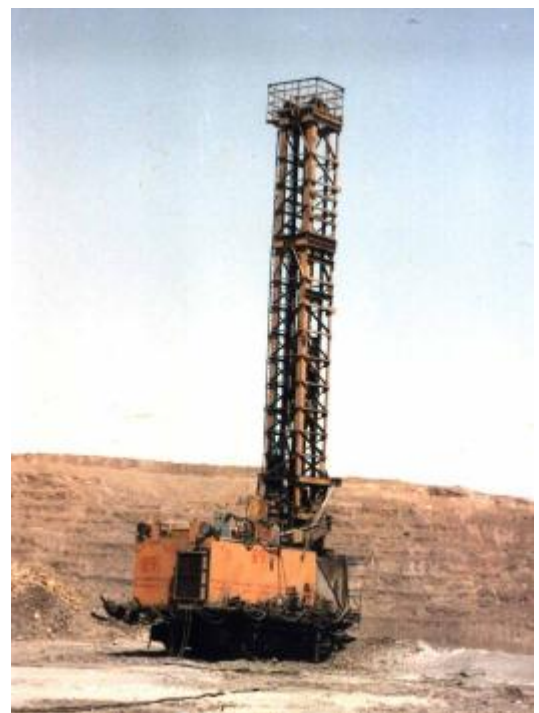
Рис. 2. Модернизированный станок СБШ-250МНА-32 с удлиненной мачтой
