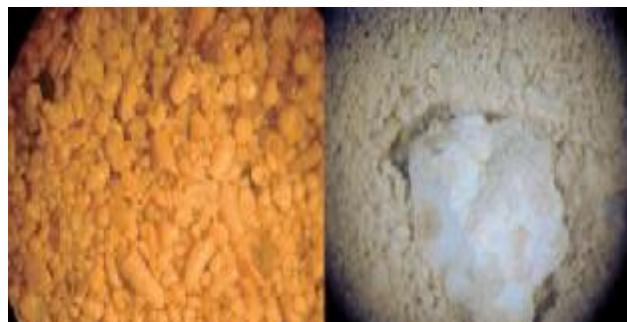
Рис. 1. Слева: обогащенная фосфатная руда (стократное увеличение); справа: солевое зерно под сканирующим электронным микроскопом
