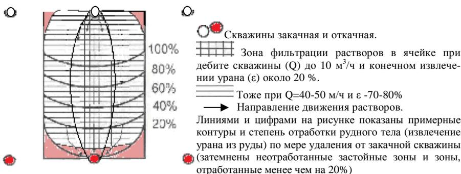
Рис. Примерная схема формирования продуктивных растворов в ячейке кислотного выщелачивания
