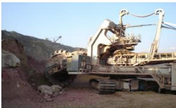
Рис. 3. Роторный комплекс № 1 фирмы «Thyssen Krupp Fördertechnik»
