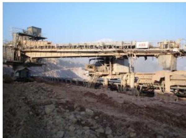
Рис. 7. Погрузка вскрышных пород
