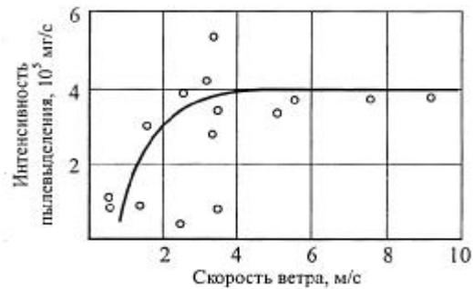
Рис. 3. Зависимость интенсивности пылевых выделений карьером от скорости ветра
