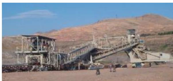
Рис. 4. Ленточно-конвейерная транспортная система
