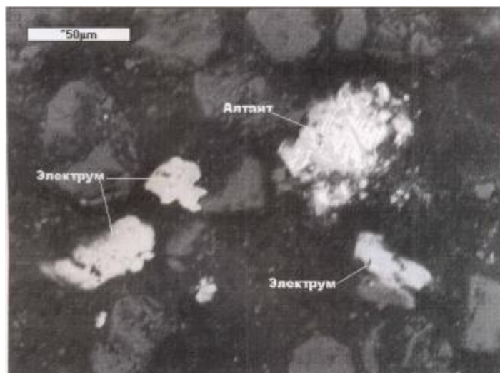
Рис. 2. Самородное золото, электрум (Au,Ag) и алтант из флотоконцентрата материала хвостохранилища АЗИФ. Снимок электронным микроскопом (ИГГ АН РУз, оператор М.А. Ким)
