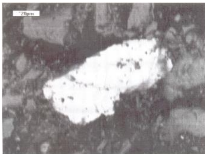
Рис.1. Самородное золото из флотоконcentрата материала хвостохранилища АЗИФ. Снимок электронным микроскопом (ИГГ АН РУз, оператор М.А. Ким)
