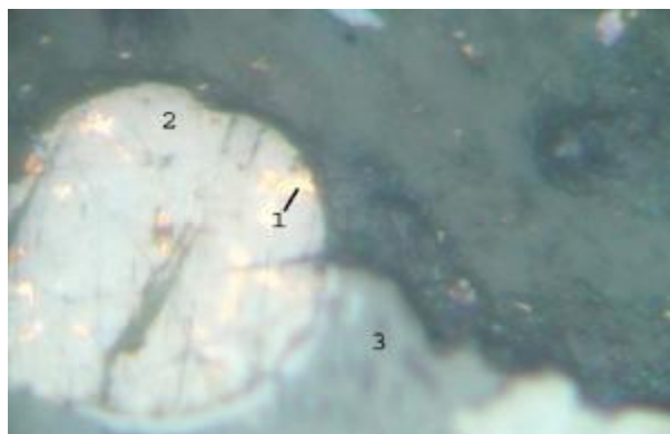
Рис. 5. Самородная медь в борнит-халькозиновом сфероиде из концентрата шлака. Аншлиф 5 а . Увел. 1300 х . ник. II. 1-медь самородная, 2-борнит-халькозиновый агрегат, 3-магнетит
