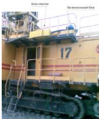
Рис. 4. Примеры размещения установки СПГО-1 на буровом станке СБШ-250 МН (а) и экскаваторе ЭКГ-15 (б)
