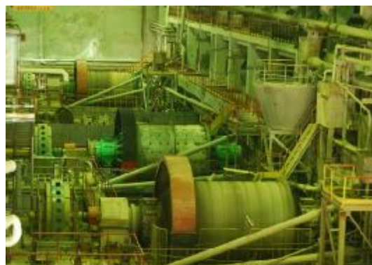
Рис. 5. Шаровые мельницы МШР 32х45 для доизмельчения промежуточного продукта
