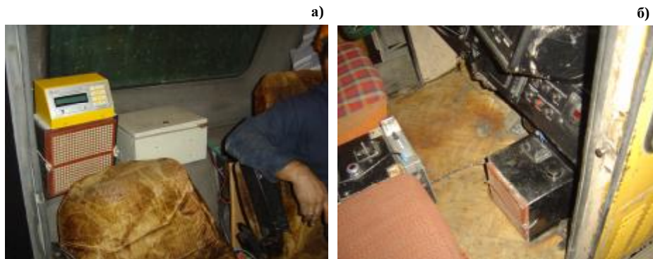
Рис. 5. Размещение установка СОВ-1 сбоку от водителя (а) и на полу кабины (б) автосамосвала
