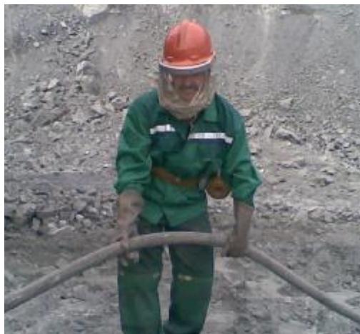
Рис. 2. Практическое применение индивидуальной установки автономного воздухообеспечения Нива-Э-2
