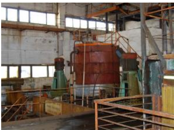
Рис. 7. Узел обезвреживания цианосодержащей пульпы «золотой цепочки»
