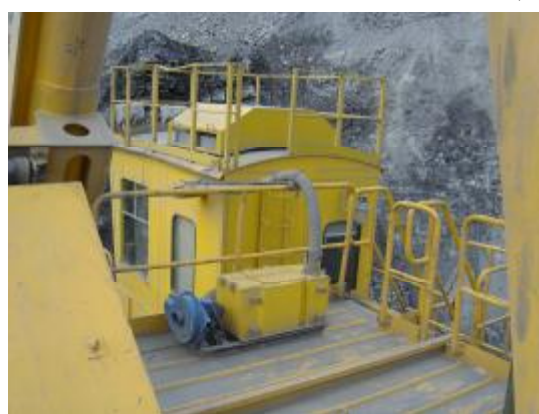
Рис. 4. Примеры размещения установки СПГО-1 на буровом станке СБШ-250 МН (а) и экскаваторе ЭКГ-15 (б)
