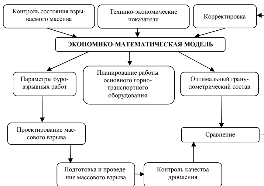
Рис. Алгоритм управления эффективными параметрами буровзрывных работ по критерию качества взорванной горной массы
