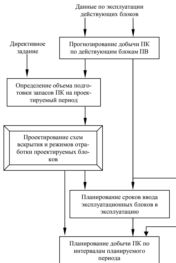
Рис. 1. Укрупненная схема составления плана горных работ для предприятия ПВ
