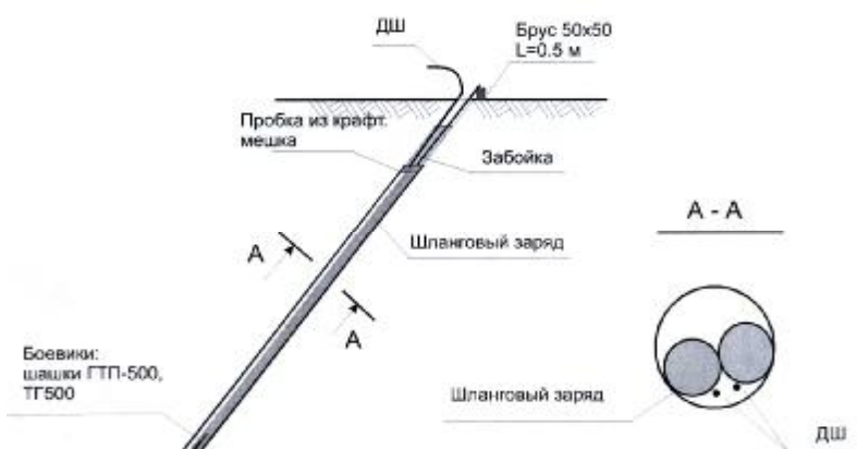
Рис. 3. Конструкция заряда ВВ в наклонной скважине
