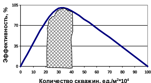
Рис. 9. Влияние удельного количества технологических скважин на эффективность шахтно-скважинной системы разработки месторождений высоковязкой нефти: зона оптимума
