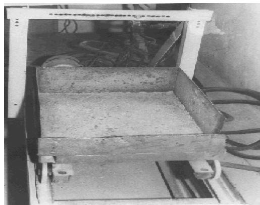
Рис. 3. Вид грунтовой тележки стационарной установки «грунтовый канал»
