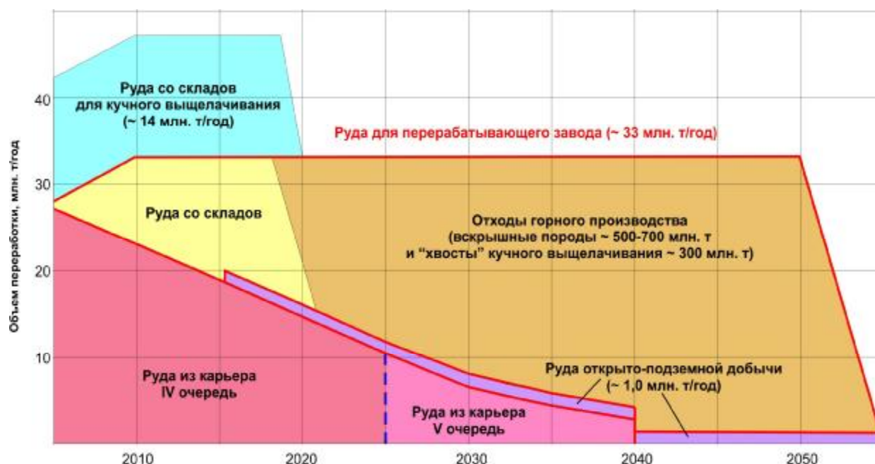
Рис. 2. Схема изменения структуры перерабатываемой рудной массы во времени
