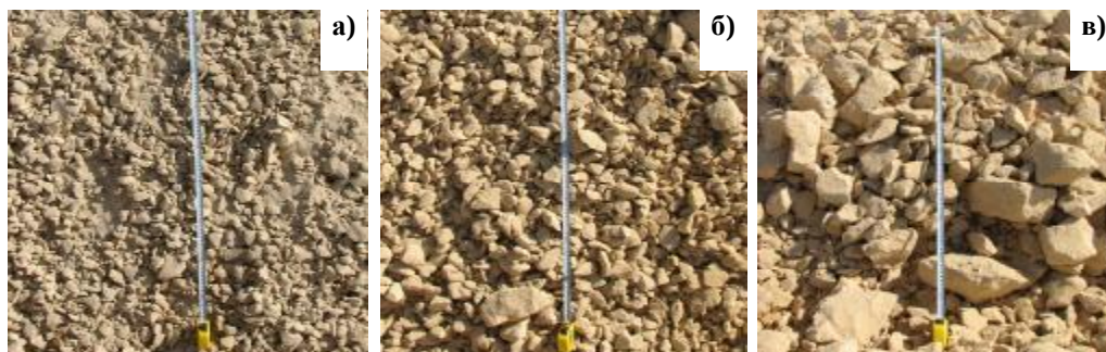
Рис. 5. Вид фракций руды в валках уложенных комбайном Wirtgen-2500SM с различными скоростями движения при фрезеровании глубиной 0,55 метров: а) 1 м/мин, б) 3 м/мин, в) 10 м/мин
