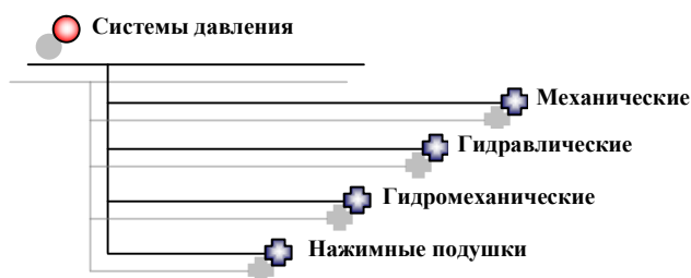
Рис. 1. Существующие системы давления вулканизационных прессов
