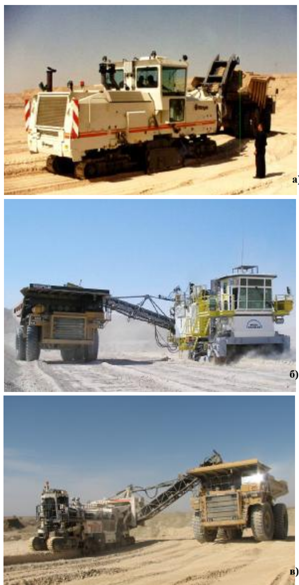
Рис. 1. Разработка фосфопласта комбайнами Wirtgen-2100SM (а), MTS-250 (б) и Wirtgen-2500SM (в) с погрузкой в самосвалы
