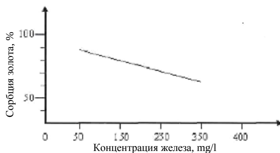
Рис. 3. Зависимость сорбции золота от концентрации железа: количество золота в растворе 5 \cdot 10^{-7} g/ml, среда 2н \text{H}_2\text{SO}_4
