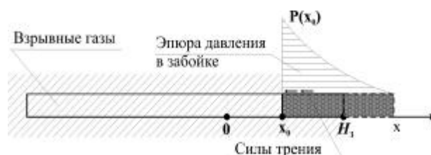
Рис. 2. Схема смещения пассивной забойки в скважине
