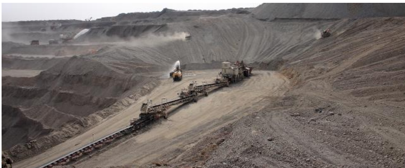
Селективная разработка вскрышных пород на внешнем складе карьера Мурунтау с подачей обогащенной части руды на кучное выщелачивание рудника ЦКВЗ
