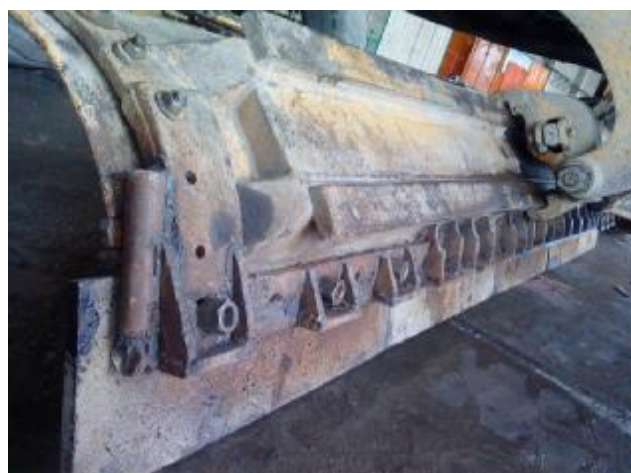
Модернизированный в УАТе отвал автогрейдера
