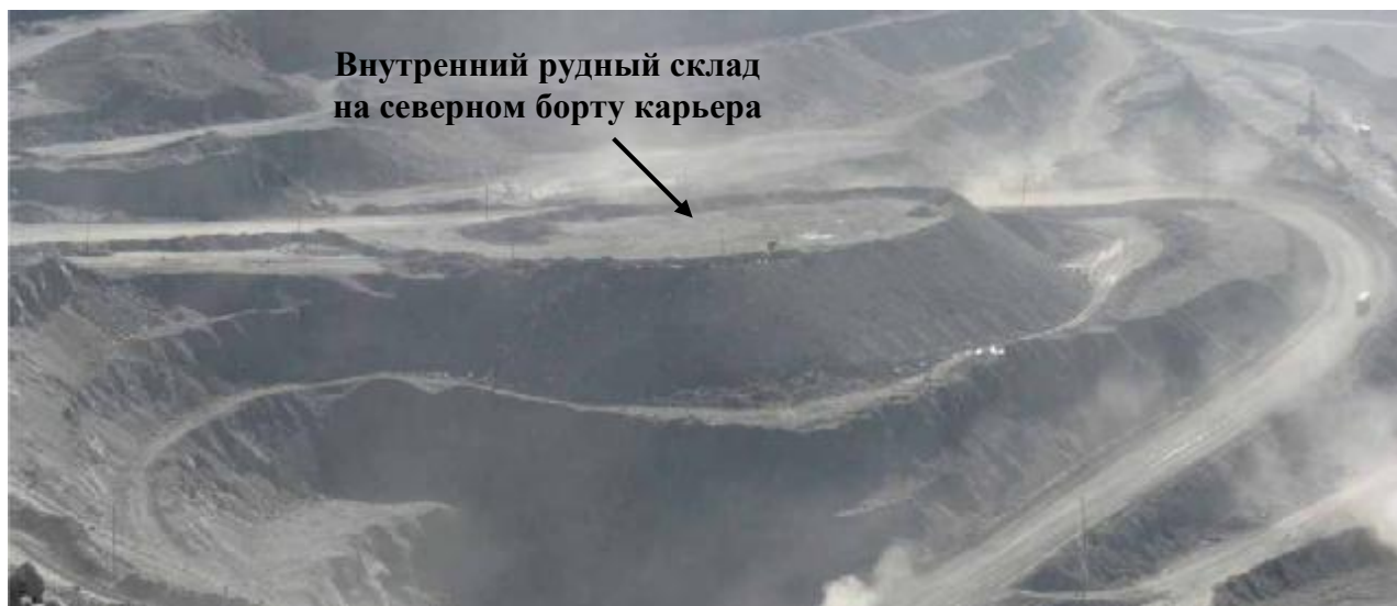
Внутрикарьерное складирование руды на внутреннем складе карьера Мурунтау
