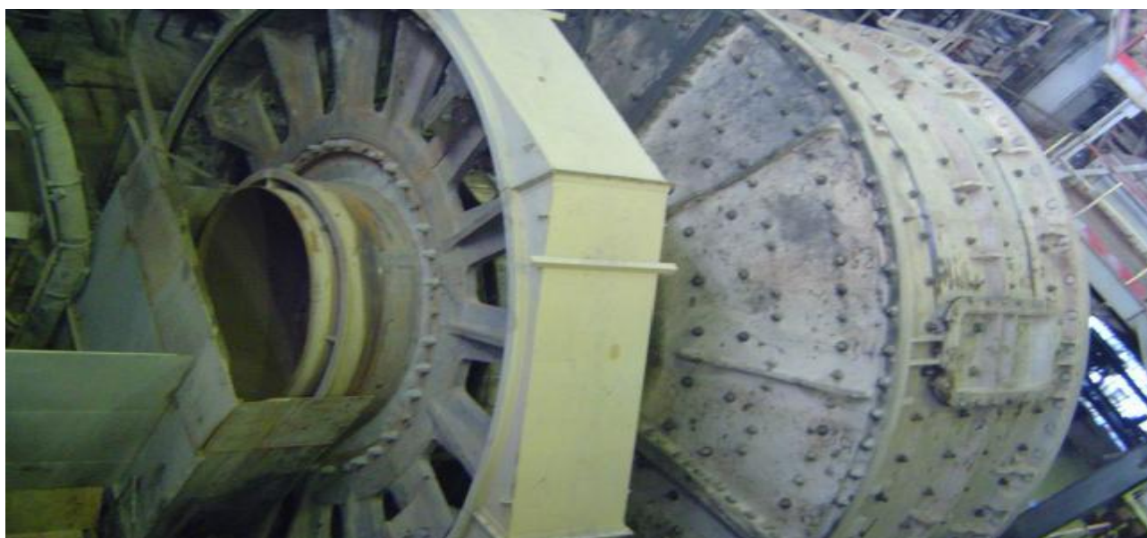
Мельница ММС 90x30 в работе на ГМЗ-2
