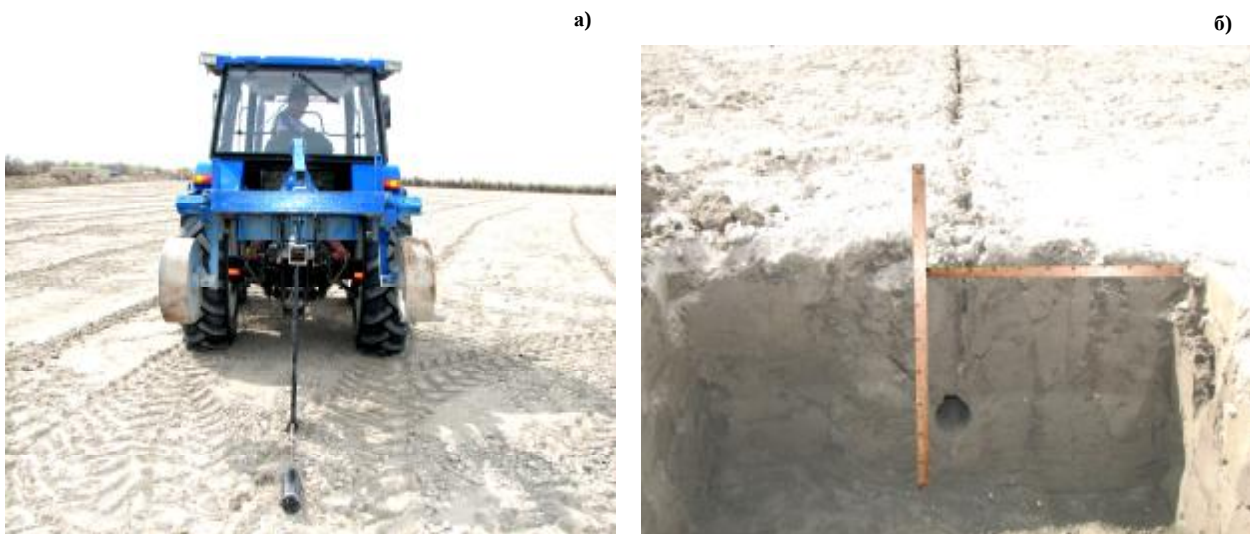
2-расм. Тажриба натижалари: а) дренаж-туйнук очувчи мослама; б) дренаж-туйнукнинг кўндаланг кесим профили
