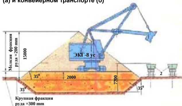
Рис. 2. Схема отгрузки руды при разделении отвала с учетом анизотропии гранулометрического состава пород
