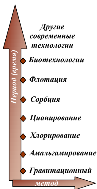
Рис. 1. Эволюция технологии переработки золотосодержащих руд
