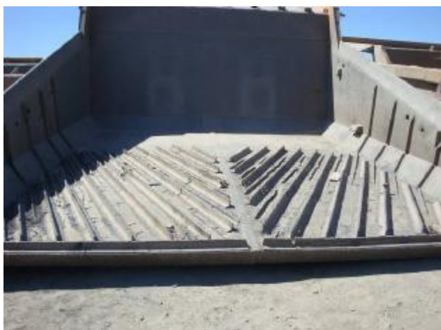
Вторичное использование металлолома в УАТе на ремонте кузовов автосамосвалов, траковых лент бульдозеров, виброкатков, при восстановлении башмаков
