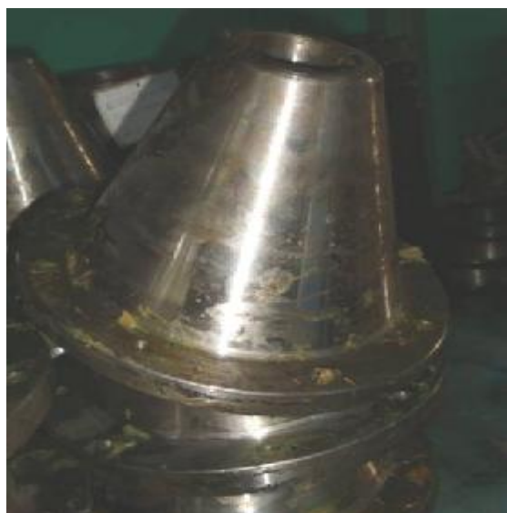
Разработанная в УАТ ступица обдува электродвигателей для БелАЗ 7513
