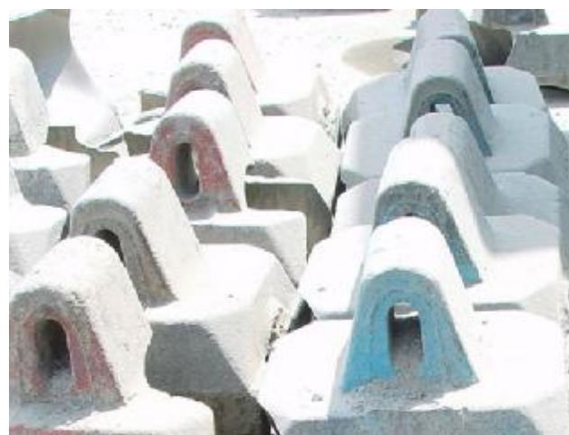
Опытная партия футеровок для дробилок 4 стадии дробления на руднике ЦКВЗ
