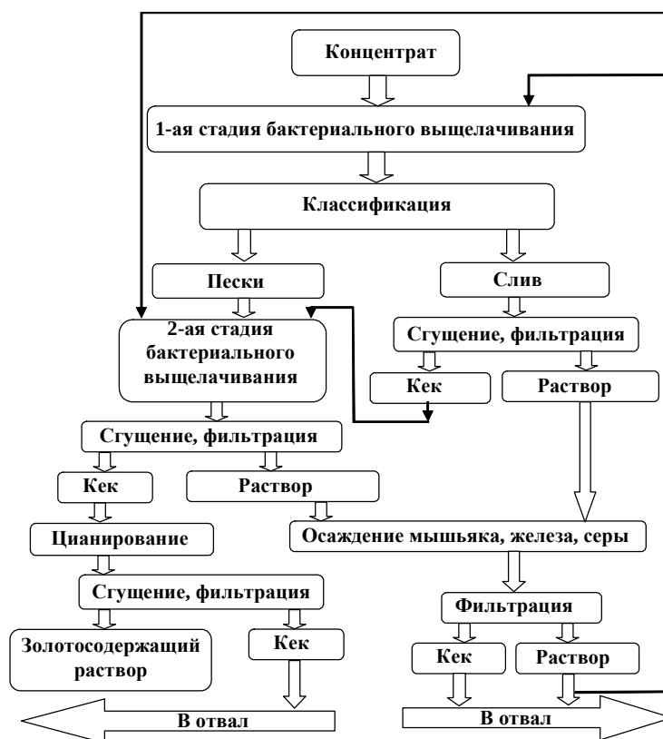
Рис. 3. Технологическая схема переработки высокомышьяковистых золотосодержащих концентратов с использованием бактериального выщелачивания
