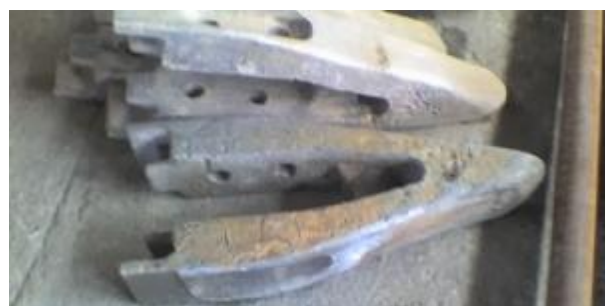
Рис. 2. Зуб, изношенный в режиме периодической переустановки
