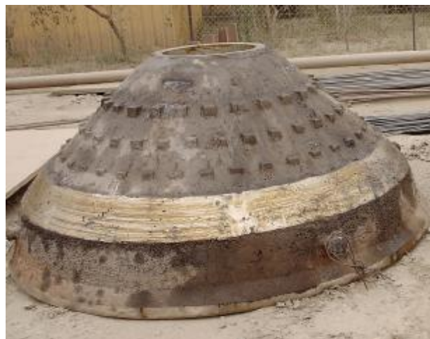
Усовершенствованная конструкция футеровки на конусе дробилки 3 стадии дробления рудника ЦКВЗ
