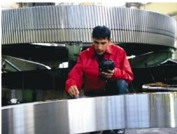
Рис. 3. Проведение НК: ультразвуковой контроль зубчатого венца
