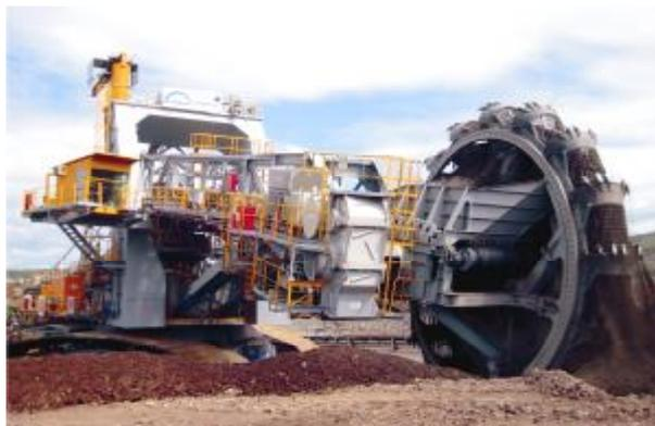
Рис. 1. Компактный роторный экскаватор SRs (H) 1050, вынимающий песок, гравий с глинистыми включениями
