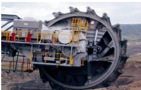
Рис. 3. Роторное колесо компактного роторного экскаватора серии SRs (H) 1050-со специальной геометрией и приводом роторного колеса, производимое на заводе Tenova TAKRAF в Лаухаммере, Германия
