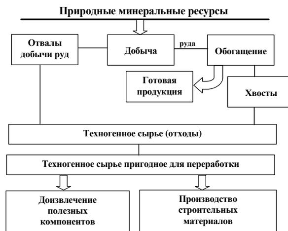
Рис. 1. Упрощенная схема формирования и использования техногенного сырья в Навоийском ГМК
