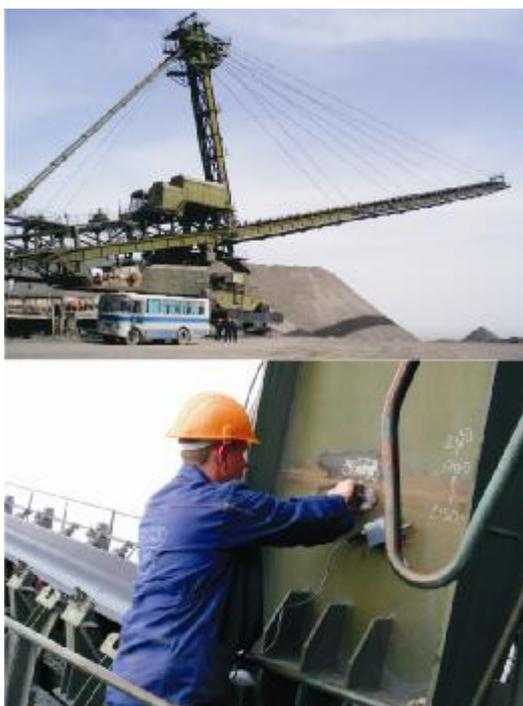
Рис. 1. Проведение НК: акустико-эмиссионный контроль отвалообразователя
