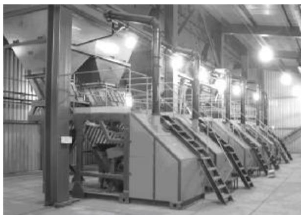
Рис. 1. Рентгенометрические сепараторы серии СРФ в цехе обогащения урановых руд РОФ ППГХО, г. Краснокаменск
