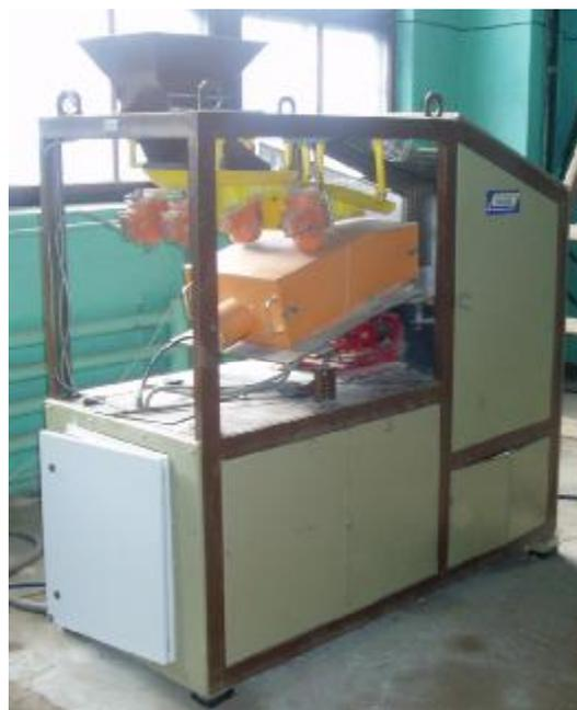
Рис. 5. Сепаратор СРФ2-30 («Малыш») для сортировки фракции крупностью 5-30 мм
