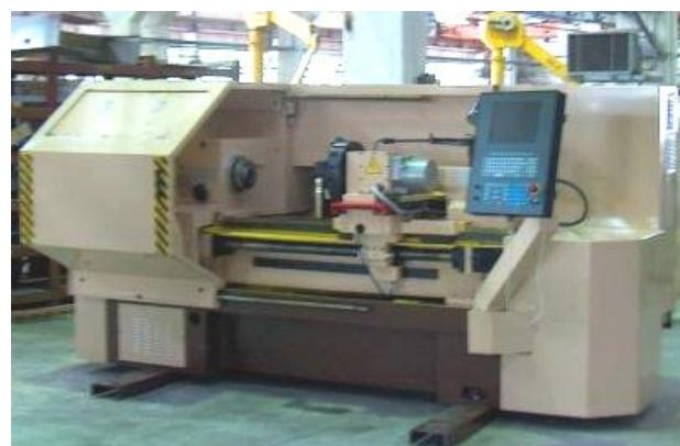
Рис. 9. Станок 16А20Ф3
