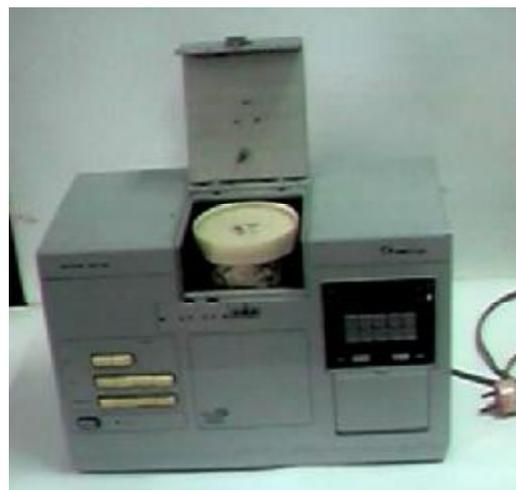
Рис. 2. Общий вид СВЧ-влагомера с микропроцессорным устройством
