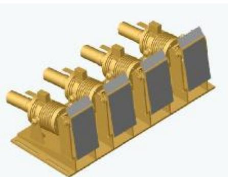
Рис. 4. Конструкция типового исполнительного электромагнитного шиберного механизма
