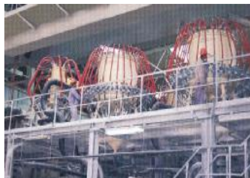
Рис. 7. Цех измельчения и сепарации первичного каолина в вихревых гидроциклонах
