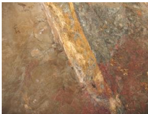
Рис. 1. Катаклазиты в скользящем звене Центрального разлома (шахтный гор. +720 м, штрек 65, 100 м от устья, кровля)
