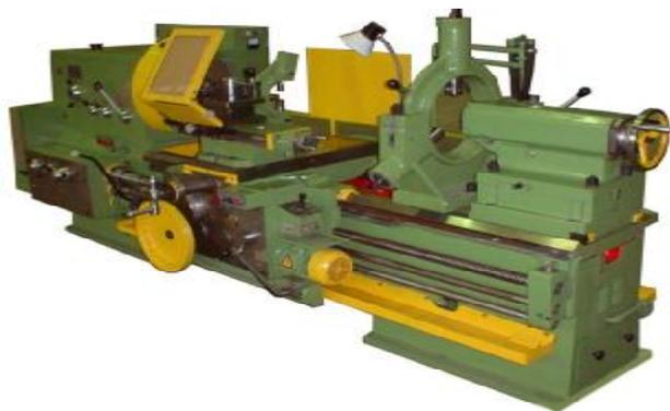
Рис. 3. Универсальный токарно-винторезный станок мод. 16К40 с РМЦ -1500 (по кооперации с ООО «РСЗ» Россия)
