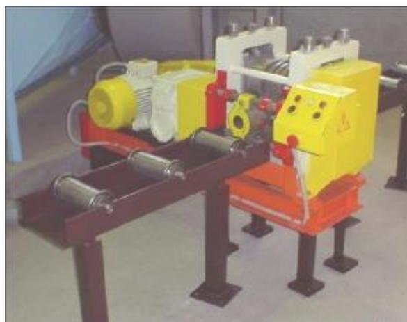
Рис. 10. Приспособление для профилирования шестигранника (ППШ)
