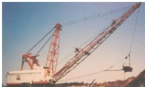
Рис. 13. Драглайн модели 1550–W компании «Busyugus–Erie» на угольном разрезе в США
