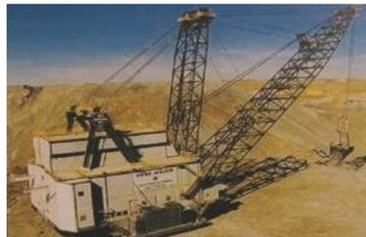
Рис. 22. Драглайн модели 2570–WS компании «Vucyrus-Erie» на угольном разрезе Black Thunder в США
