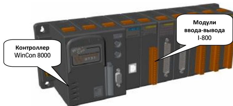
Рис. 4. Контроллер WINCON-8000 производства ICPDAS inc
