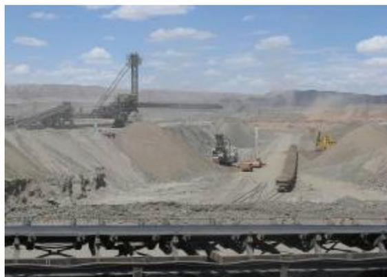
Рис. 2. Доставка руды конвейерными линиями на перегрузочный пункт карьера
