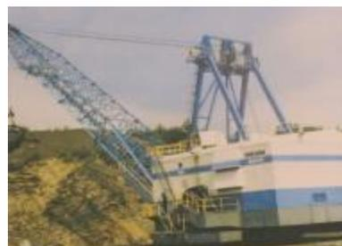
Рис. 21. Драглайн Marion 7450 модульной конструкции
