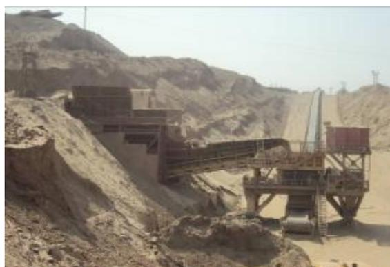
Рис. 4. Перегрузочный пункт с ДШЗ и выносным конвейером традиционного исполнения
