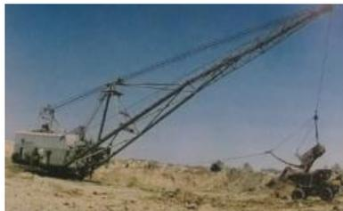
Рис. 28. Драглайн ЭШ – 6/45 на разработке вскрышных отвалов с погрузкой в автосамосвалы
