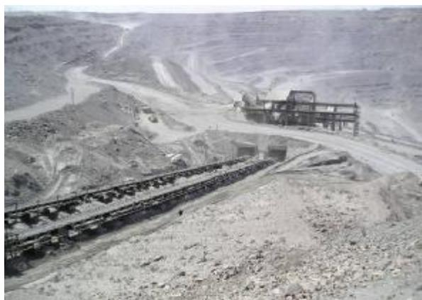
Рис. 1. Наклонные конвейеры комплекса ЦПТ
