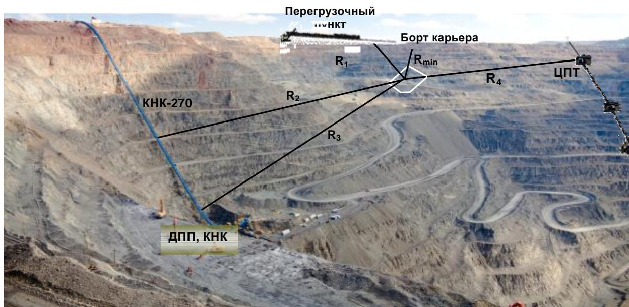
Рис. 1. Ориентация площадки взрываемого блока относительно нескольких охраняемых объектов:  $R_1=120$  м;  $R_2=750$  м;  $R_3=720$  м;  $R_4=480$  м,  $R_{\text{min}}=80$  м – расстояние от взрывного блока до охраняемых объектов
