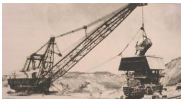
Рис. 9. Драглайн модели 1150-B на погрузке материала в дробилку на карьере South Mine в США
