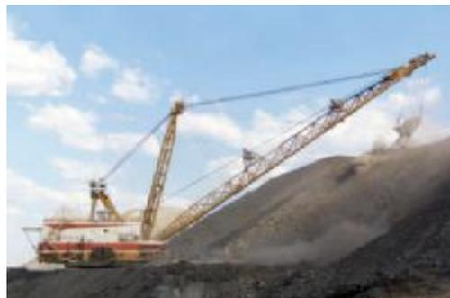
Рис. 24. Драглайн модели 9020 компании P&H на угольном разрезе Blackwater (Австралия)
