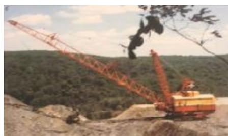
Рис. 11. Драглайн модели 1260-B компании «Busyugus – Erie» на вскрышных работах
