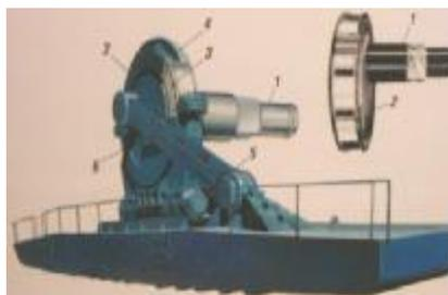
Рис. 15. Ходовой механизм «Cam and slide»
