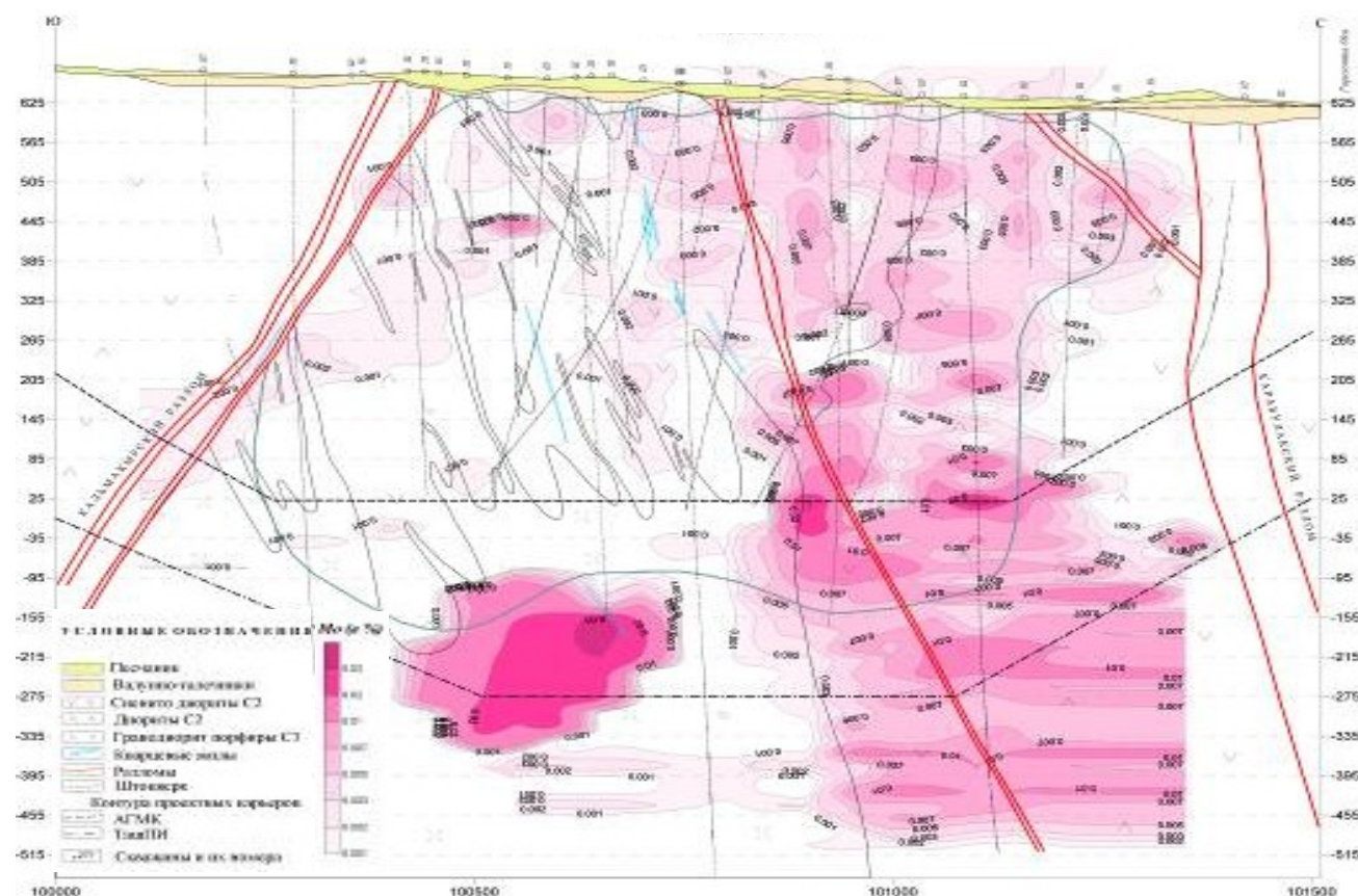
Рис. 2. Месторождение Дальнее (участок Центральный). Разрез по линии III-III. Ореолы распределения молибдена. Масштаб 1:5000
