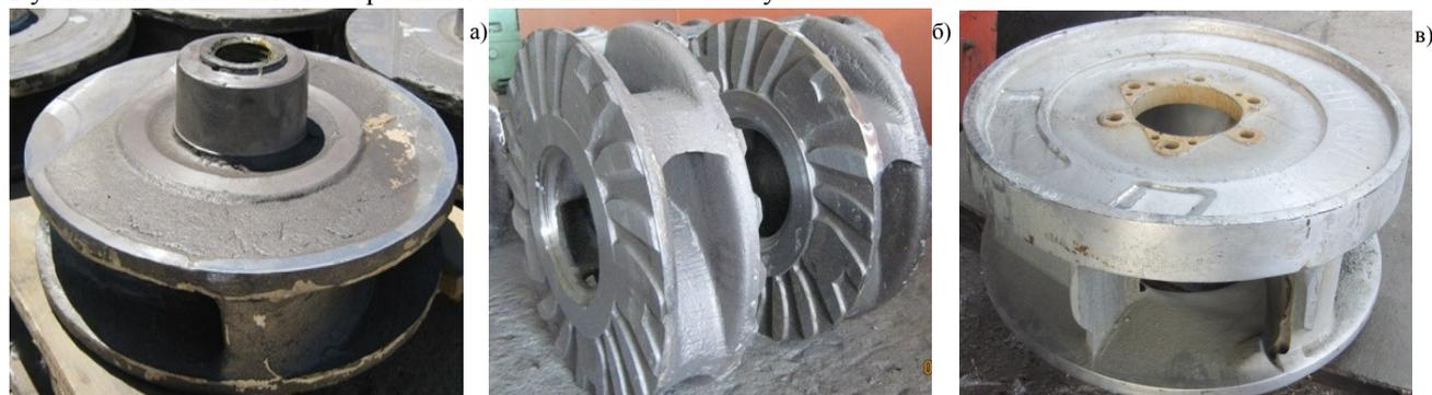
Рис. 1. Чугунные отливки рабочих колес насосов «8Гр» (а), «Wagman» (б) и ротора барабана дробилки «СЕМСО» (в)
