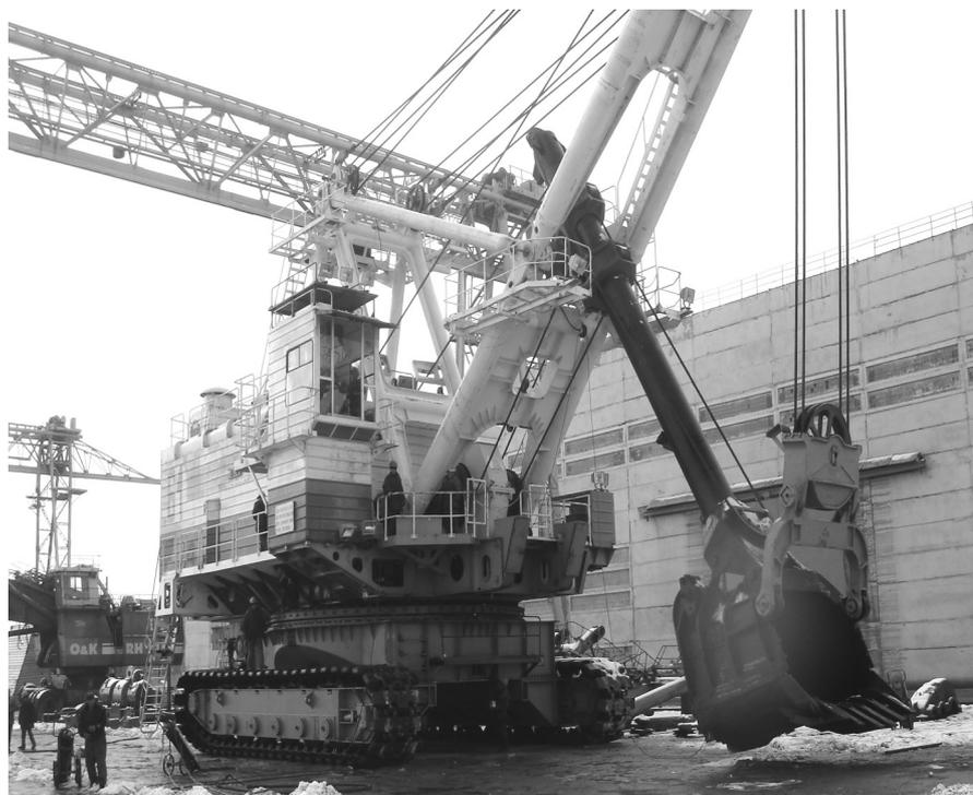
Рис. 1. Замена рабочего оборудования ЭКГ
