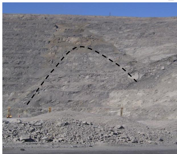
Рис. 1. Деформация на карьере Мурунтау: --- контур деформации
