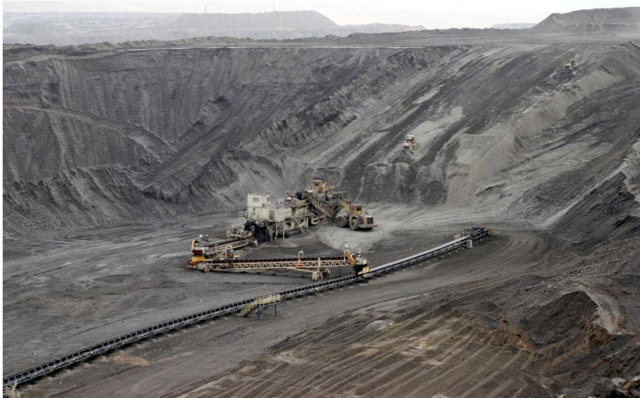
Рис. 2. Добыча руды из забалансовых складов
