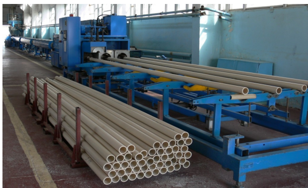
Рис. 2. Линия по изготовлению поливинилхлоридных труб
