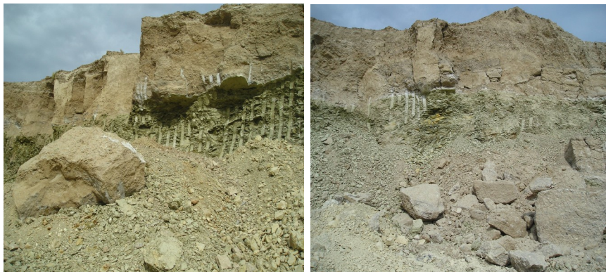
Рис. 1. Образование негабаритов в верхней части разнопрочного вскрышного массива из гравелита и глины на месторождении Джерой-Сардара при взрывании сплошных скважинных зарядов
