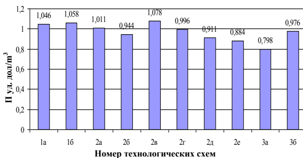
Рис. 1. Номограмма для оценки технологических схем по удельным приведенным затратам при постоянном ежегодном объеме вскрыши: 1а - драглайн ЭШ25/125; 1б - драглайн ЭШ40/130; 2а - экскаватор ЭРШР-5000, отвалообразователь ОШР - 5000/190; 2б - экскаватор SChRS 1760/5.30, отвалообразователь AP 4400/140; 2в - экскаватор SRS 2000/6.33, отвалообразователь AP 4400/140; 2г - междупластье: экскаватор- SRS 400/1.14, отвалообразователь - AP 2500/70; внешняя вскрыша: экскаватор SRS 1000/1.20, отвалообразователь AP3800/90; 2д - междупластье: - экскаватор SChRS 700/1.16, отвалообразователь AP 3000/80, внешняя вскрыша: экскаватор SChRS 750/5.28, отвалообразователь AP4200/90; 2е - междупластье: экскаватор ЭРП1250/1.16, отвалообразователь ОШР4500/90, внешняя вскрыша: экскаватор ЭРП5250, отвалообразователь ОШР-4590; 3а - экскаватор RH 170 ( V_k=18 \text{ м}^3 ), автосамосвал МТ 3300 ( r/n = 150 \text{ т} ); 3б: экскаватор RH 170 ( V_k=18 \text{ м}^3 ), автосамосвал МТ 3300 ( r/n=150 \text{ т} )
