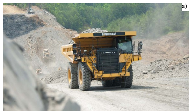
Рис. 2. Большегрузные автосамосвалы: а) CAT-777 б) БелАЗ-75570
