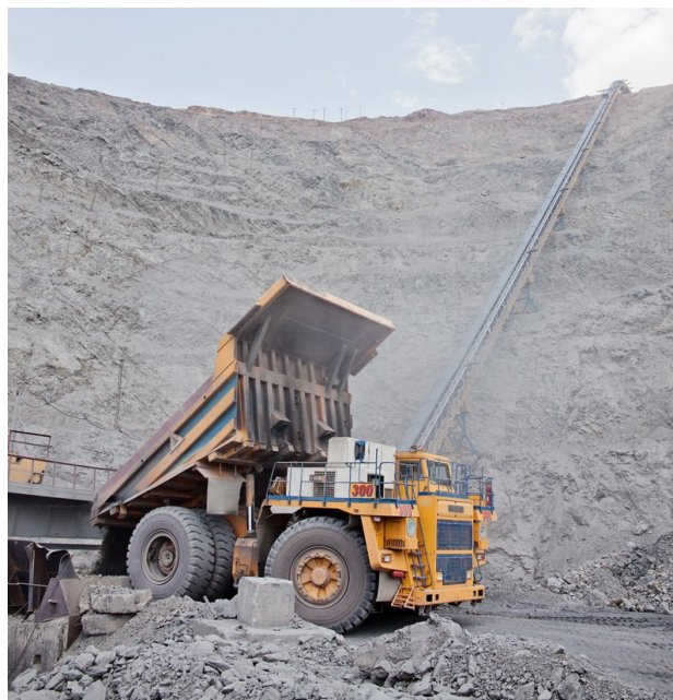
Рис. 1. Транспортировка горной массы крутонаклонным конвейером
