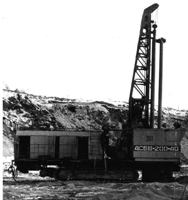
Рис. 1. Карьерный буровой станок 4СБШ-200-40 с ВПМ патронного типа
