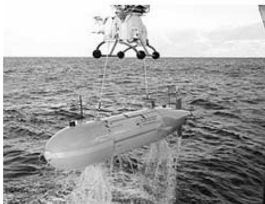
Рис. 1. Подъем подводного робота «Autosub-6000»
