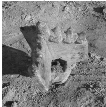
Рис. 6. Пикобур, изготовленный из отработанного шарошечного долота
