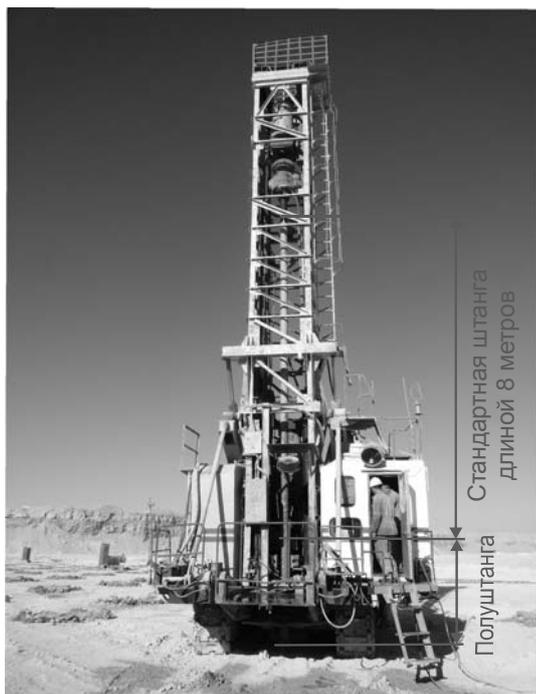
Рис. 7. Использование полуштанги на буровом станке СБШ-250МНА
