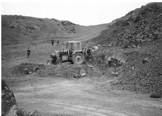
Рис. 1. Процесс добычи базальтов «Асмансайского» месторождения с помощью погрузочного трактора
