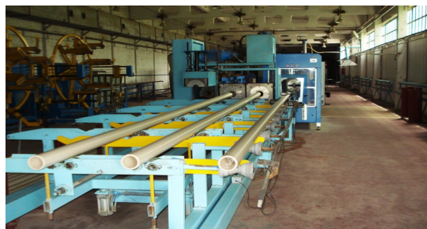
Рис. 4. Линия по изготовлению поливинилхлоридных труб ЦППТиИ ЮРУ
