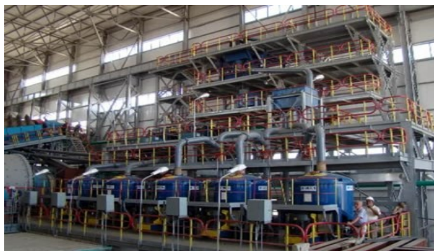
Рис. 3. Отделение измельчения и гравитации ГМЗ-4, концентратор FALCON-SB-5200
