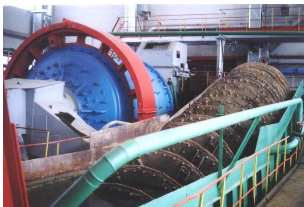
Рис. 9. Мельница МШЦ 32x31 с классификатором 1КСП-24
