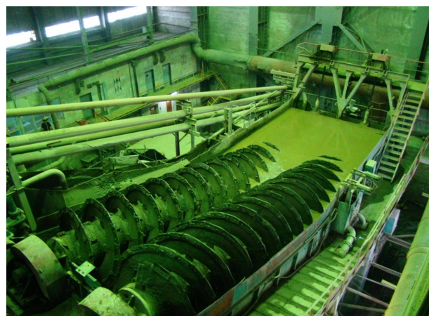
Рис. 7. Спиральный классификатор 2КСП-24
