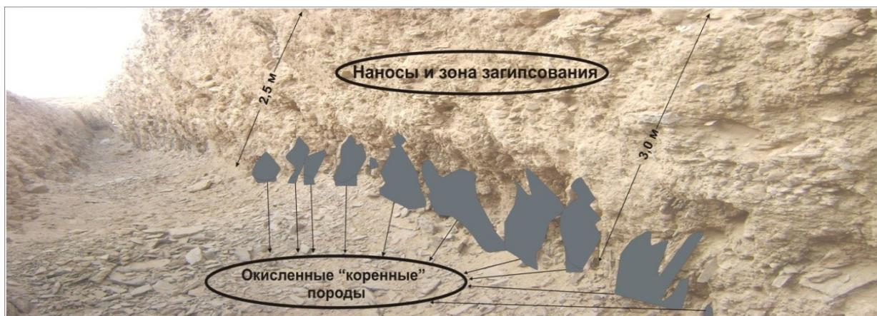
Рис. 1. Фактическая вскрываемость «коренных» пород (траншея)
