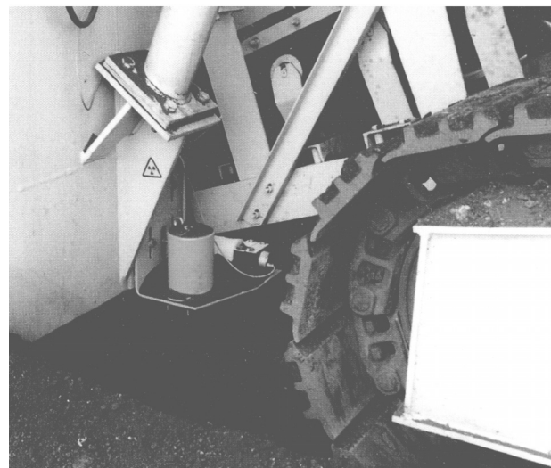
Рис. 2. Устройство распознавания границ пластов
