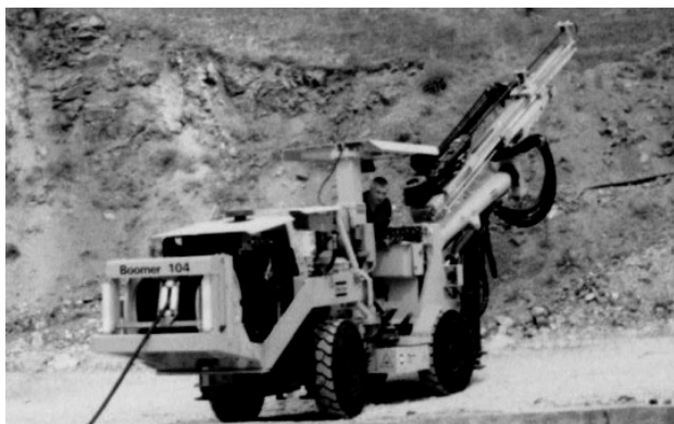
Рис. 1. Гидравлическая буровая установка Boomer 104-1238 фирмы Atlas Copco
