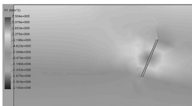
Рис. 4. Эпюра главного напряжения \sigma_1 . Направлены вкрест выемки. Красным цветом оконтуривается зона растяжения
