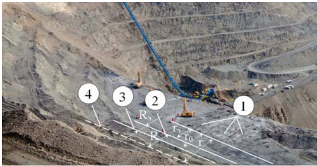
Рис. 1. Схема к расчёту коэффициента эффективности применения контурного взрывания: 1 – заряды дробления в приконтурной зоне; 2 – проектный контур (экранирующая щель); 3 – граница зоны остаточных деформаций при наличии экранирующей щели; 4 – границы зоны остаточных деформаций при взрыве без экрана
