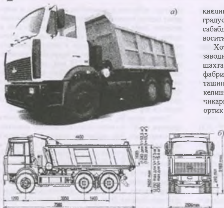
1-расм. МАЗ-651608 русумли автосамосвал: а) куруниши ва б) курсаткичлари.
