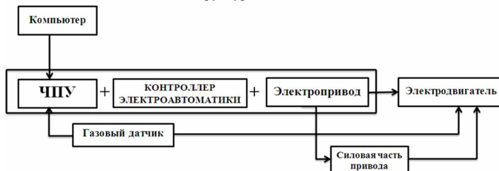
Рис. 3. Структура системы ЧПУ.
