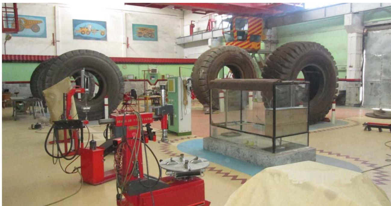
Отделение по ремонту крупногабаритных шин по технологии ф. TIR-TOP.
