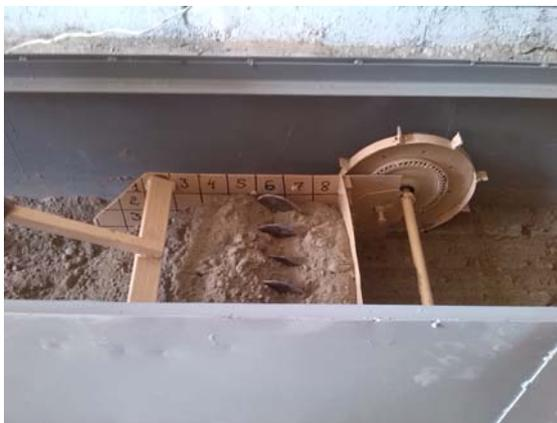
4-расм. Тупроқ уюмининг қиялигини шнекли ковш макети ичида кўриниши.
