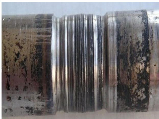
Рис. 1. Износ вала при трении на рабочее колесо
