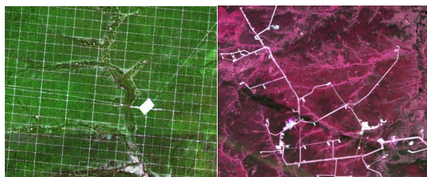
Рис. 2. Фрагменты снимков с гистограммой, подстроенной под выявление технологических площадок и сейсмопрофилей, расположенных в лесном массиве
