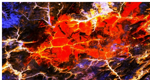
Рис. 4. Фрагмент снимка Landsat 8 с гистограммой, подстроенной под выявление гари (2 коротковолновых и ближний инфракрасный спектры)
