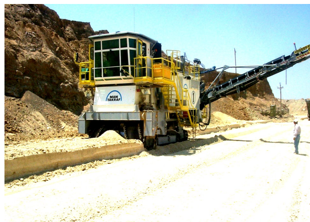
Рис. 4. Послойная выемка фосфоритов комбайном MAN TAKRAF «MTS-250»
