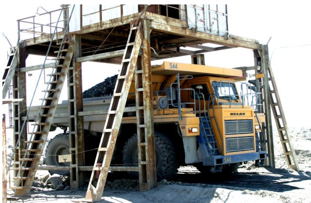
Рис. 1. Рентгенометрическое опробование порции горнорудной массы в кузове автосамосвала рудоконтрольной станции (РКС) месторождения Кокпатас.
