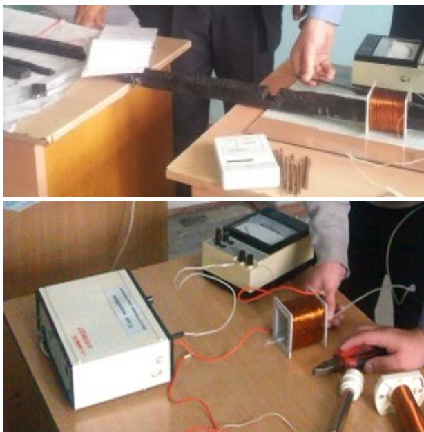
Рис. 3. Использование катушки индуктивности при поиске обрыва резинотросовых лент.
