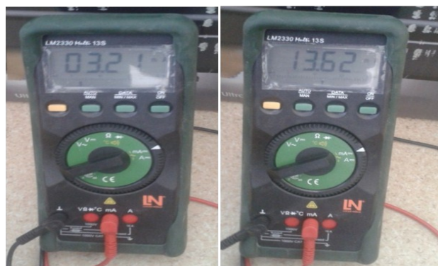
Рис. 4. Показание амперметра с изменением числа проходимых тросов РТЛ.
