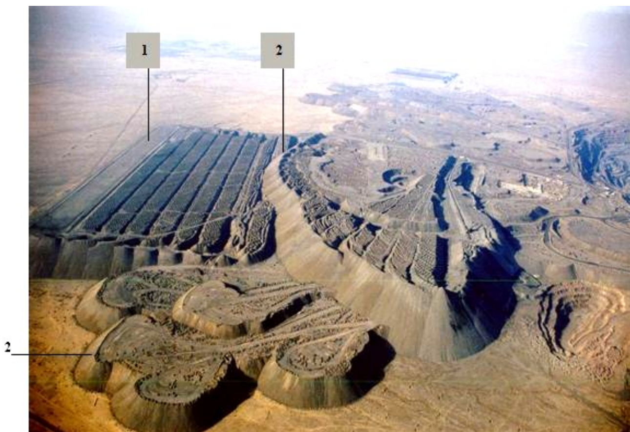
Рис. 2. Конвейерные (1) и автомобильные (2) отвалы карьера «Мурунтау».
