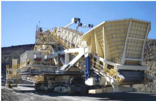
Рис. 4. Мобильная дробильная установка TMCS Тенова TAKRAF с двухвалковой дробилькой на угольном разрезе «Клермонт» (Австралия) производительностью 12 тыс. т/ч
