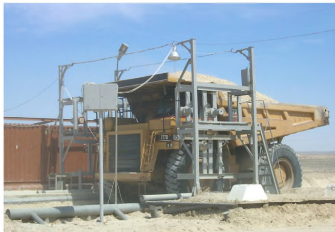
Рис. 13. Радиометрическое опробование порции фосфоритов в кузове автосамосвала на рудоконтрольной станции РКС-Ф
