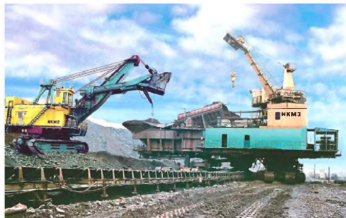
Рис. 2. Самоходный дробильно-перегрузочный агрегат ДПА-2000 производства ПАО «Новокраматорский машиностроительный завод (НКМЗ) на опытно-промышленном участке Центрального ГОКа (Кривбасс)
