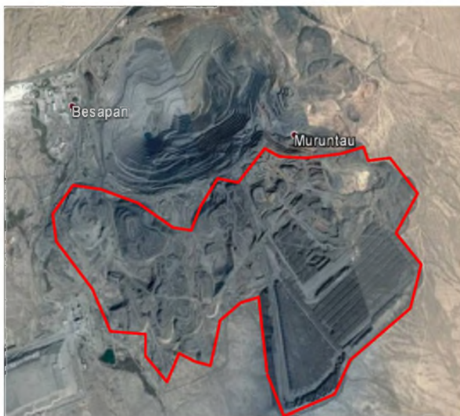
Рис.2. Склады забалансовых руд и отвалы минерализованной массы рудника Мурунтау
